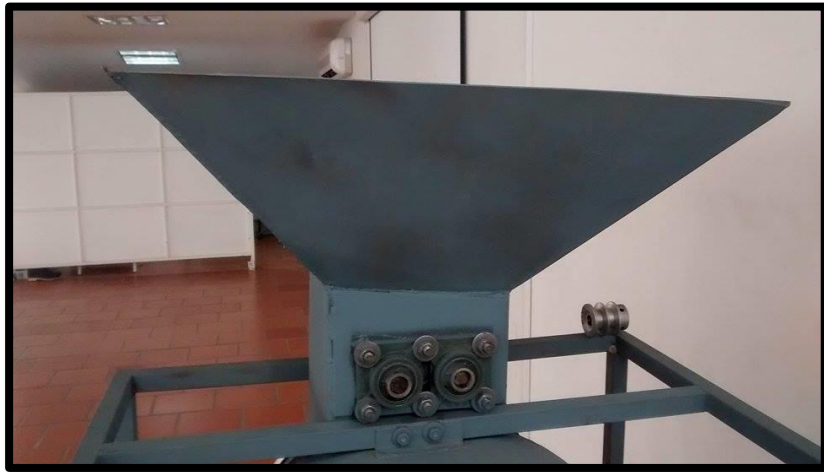
Figura 36. Montaje de la tolva a la estructura.
