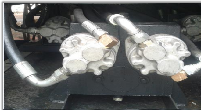
Imagen 7. Sistema de bombeo de accionamiento hidráulico.
