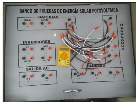
Figura 66. Tablero de conexiones, puentes y multímetro.
