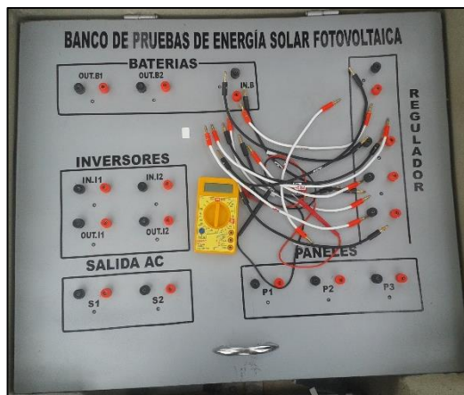
Figura 56. Tablero de conexiones, puentes y multímetro.
