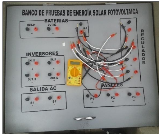
Figura 63. Tablero de conexiones, puentes y multímetro.
