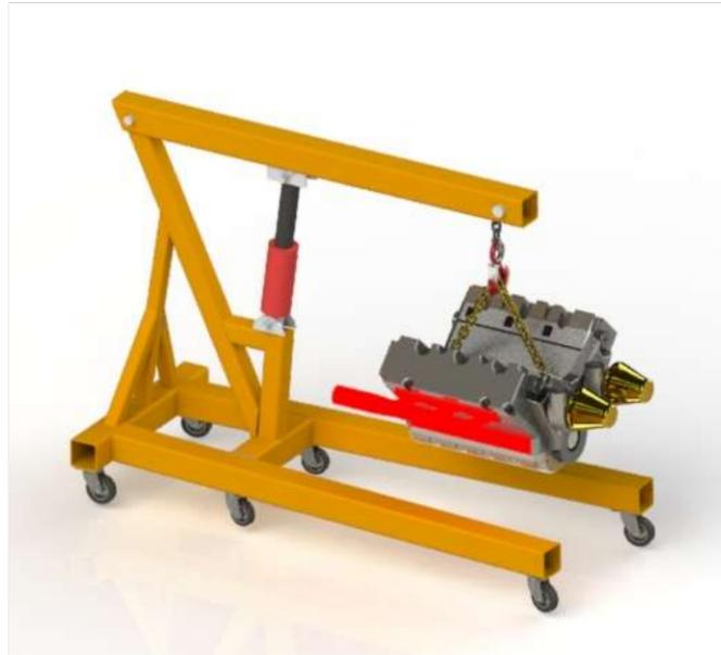
*Nota.* Diseño del prototipo, ensamblado en el programa SolidWorks a partir de las condiciones deseadas.
