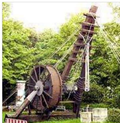
El Polyspasto podía levantar hasta 3.000 kg ( $3 \text{ cuerdas} \times 5 \text{ poleas} \times 4 \text{ hombres} \times 50 \text{ kg} = 3.000 \text{ kg}$ ), el mismo que doblaba su carga máxima a 6000 kg con solo la mitad del equipo. Sin embargo, se asume que los ingenieros romanos lograron la elevación de estos pesos extraordinarios por medio de una torre (UNITEC, 2016).
