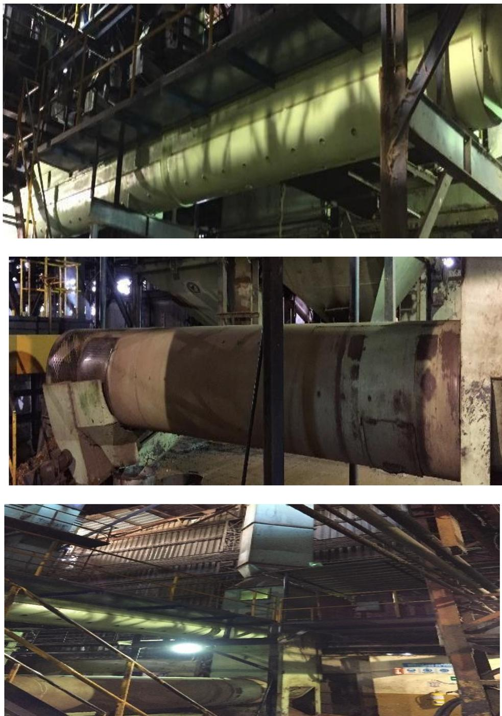
**Figura 15.** Transportador secador de torta – Tambor pulidor – Ciclón de fibra
