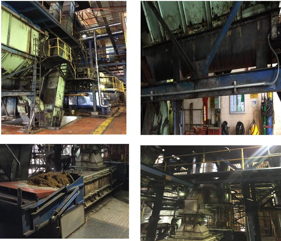
**Figura 13.** Elevador de fruto – sin fin debajo del desfrutador– prensa p-15 malaya – digestor
