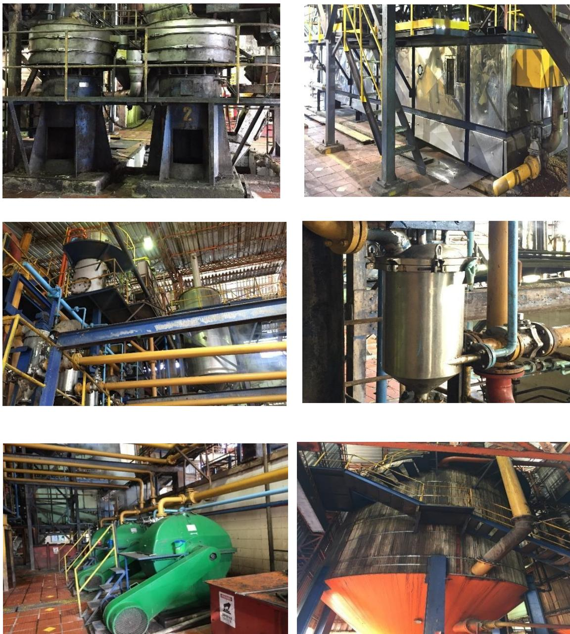
**Figura 14.** Tamiz de aceite – Tanque preclarificador – Secador de vacío – Tanque de agua caliente – Filtro rotatorio – Centrifugas de lodo – Tanque clarificador de aceite.
