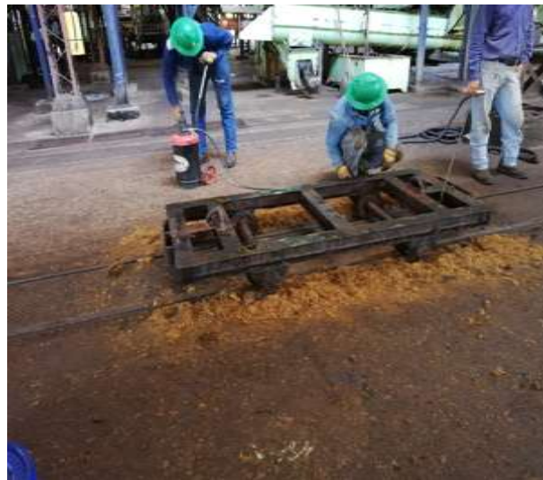
Figura 28 Lubricación de chasis
