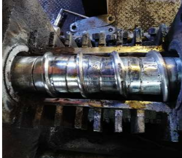
Figura 16 Extracción de canasta prensa de palmiste
