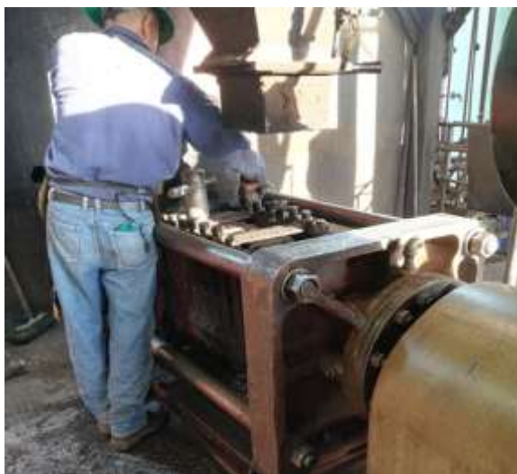
Figura 15 Desmonte tornillería prensa palmiste
