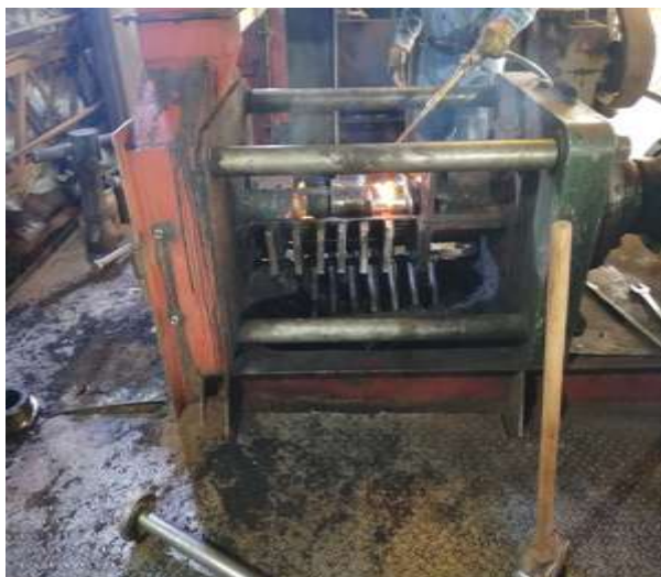
Figura 17 Desmonte de caracoles de la prensa de palmiste
