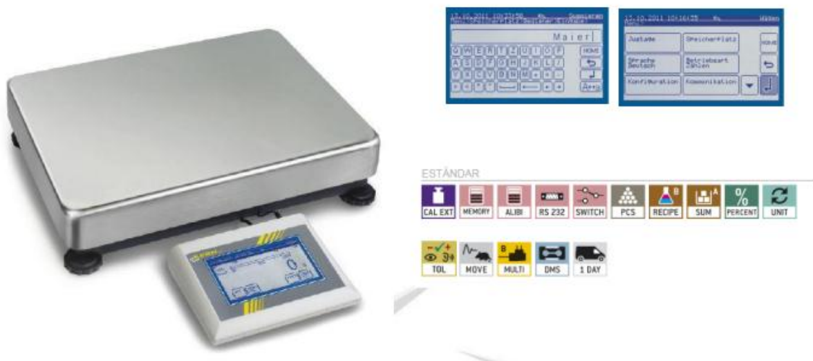
Figura 20. Balanza de plataforma de pantalla táctil marca Kern de Alemania, modelo IKT 100K0.5L. Capacidad 100 Kg x 500 mg.
