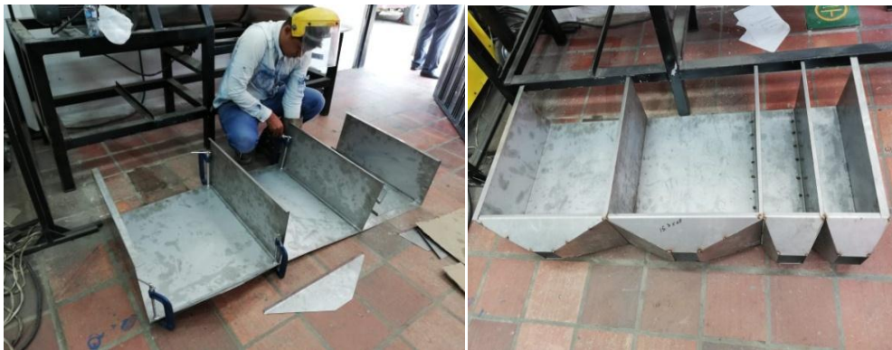
Figura 21. Fase de soldadura en el diseño de tolvas.
