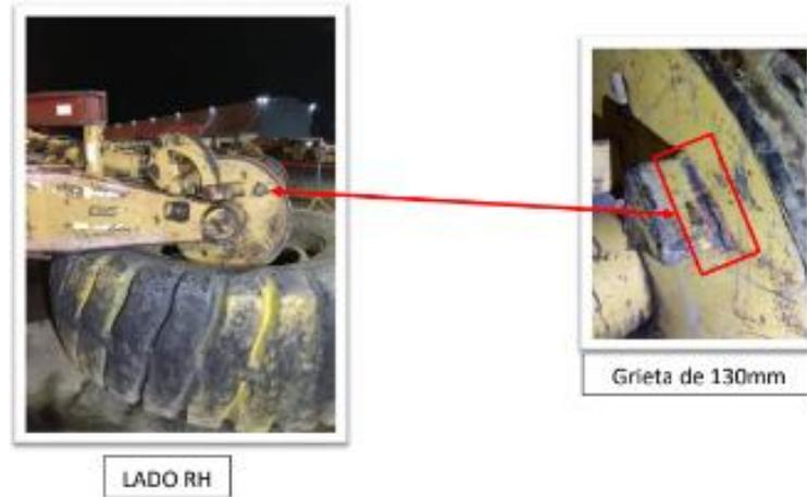
Figura 11. Grietas en el plato derecho del manipulador.
