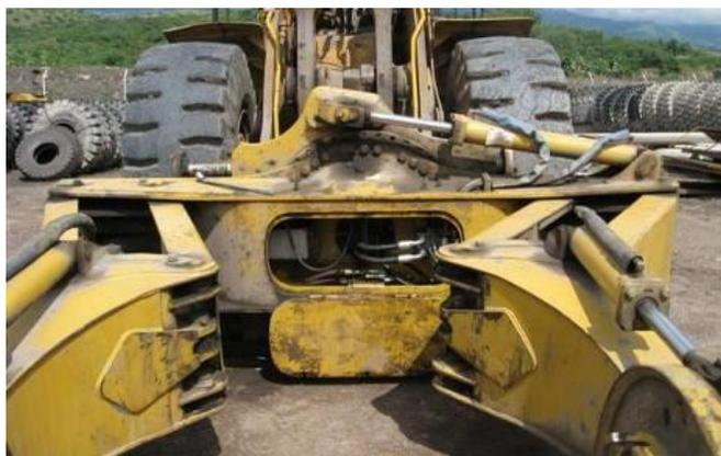
Figura 12. Cilindro que genera el giro de las pinzas, localizado en el tornamesa del equipo.
