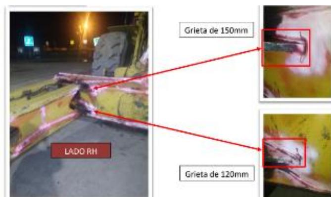
Figura 10. Grietas en la lámina frontal de los brazos de las pinzas lado derecho.
