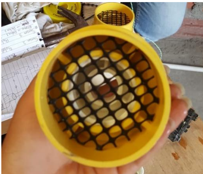
Figura 63 Malla del filtro del medio poroso.
