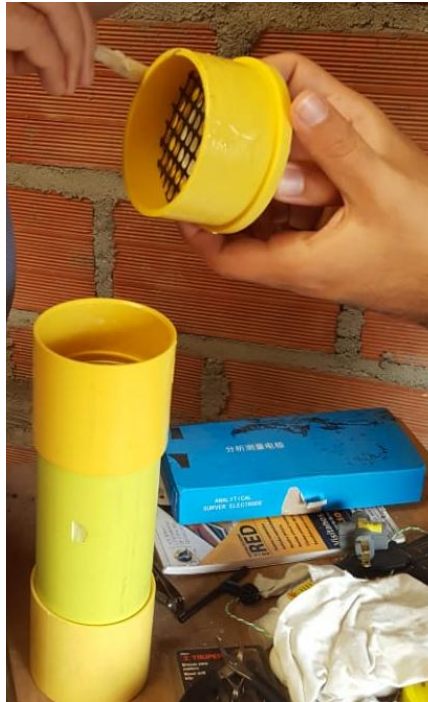
Figura 64 Construcción del filtro con medio poroso.
