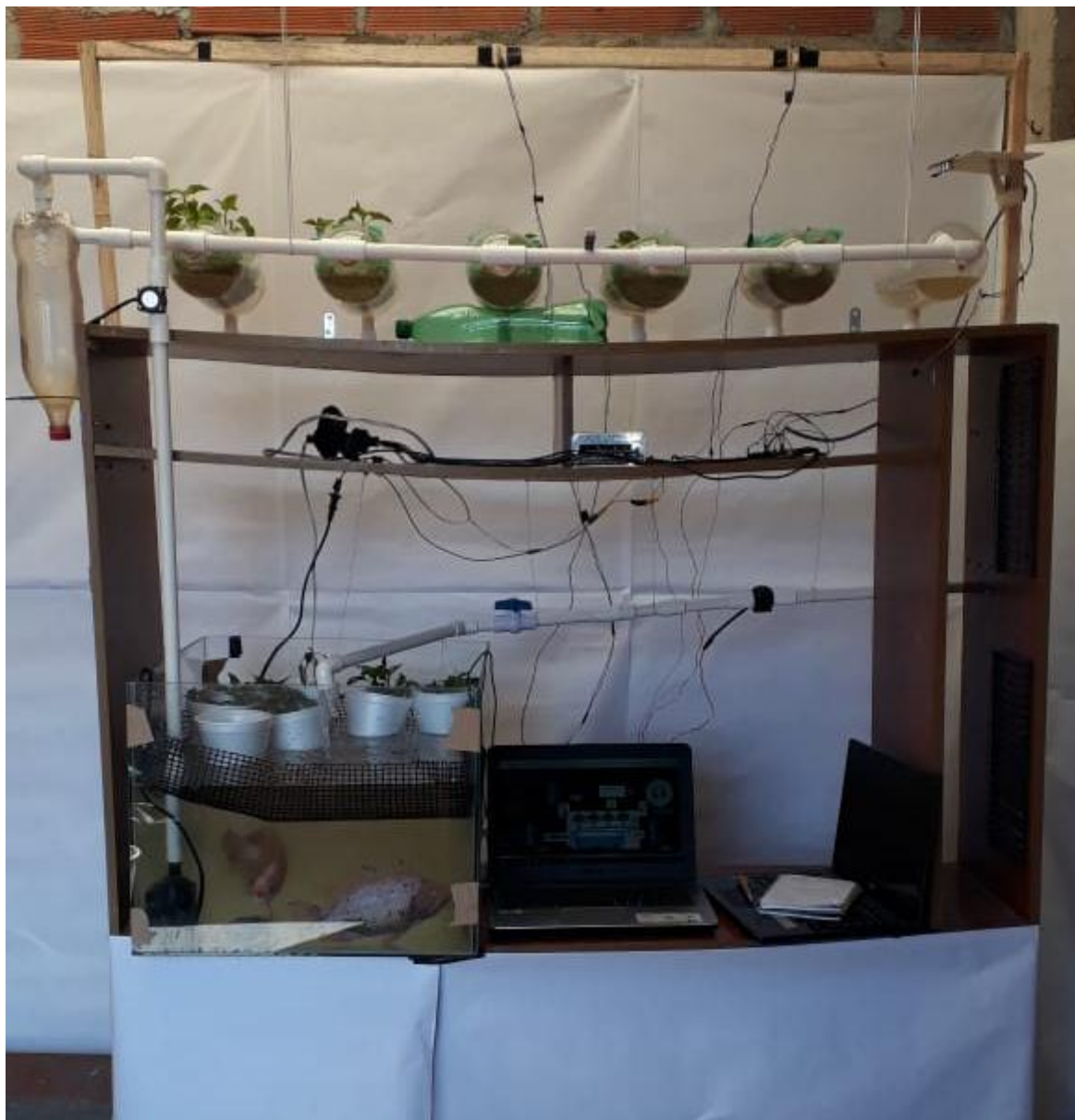
Figura 16 Huerta urbana automatizada con sistema acuapónico.
