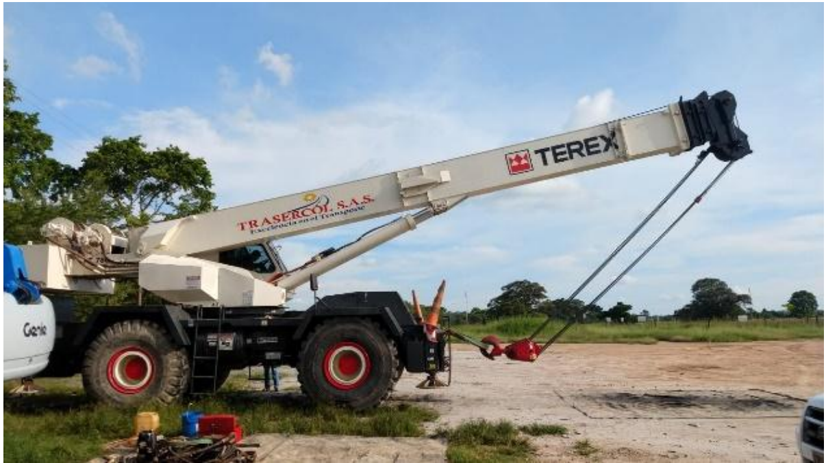
Figura 2. Grúa Terex RT 780
