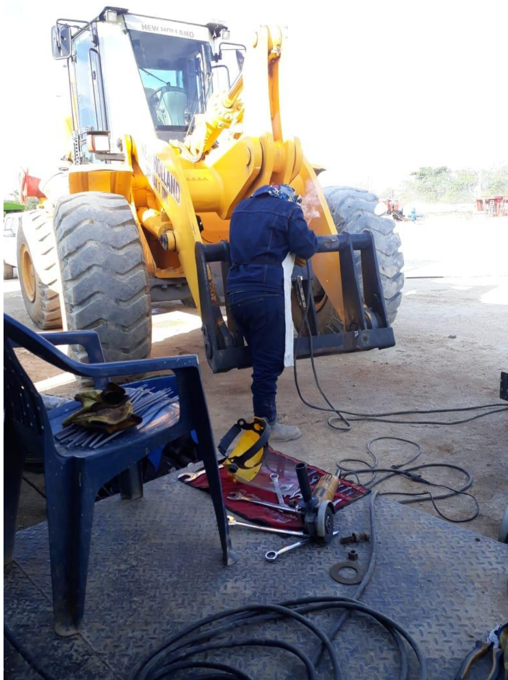
Figura 73. Soldadura de uñas W190C
