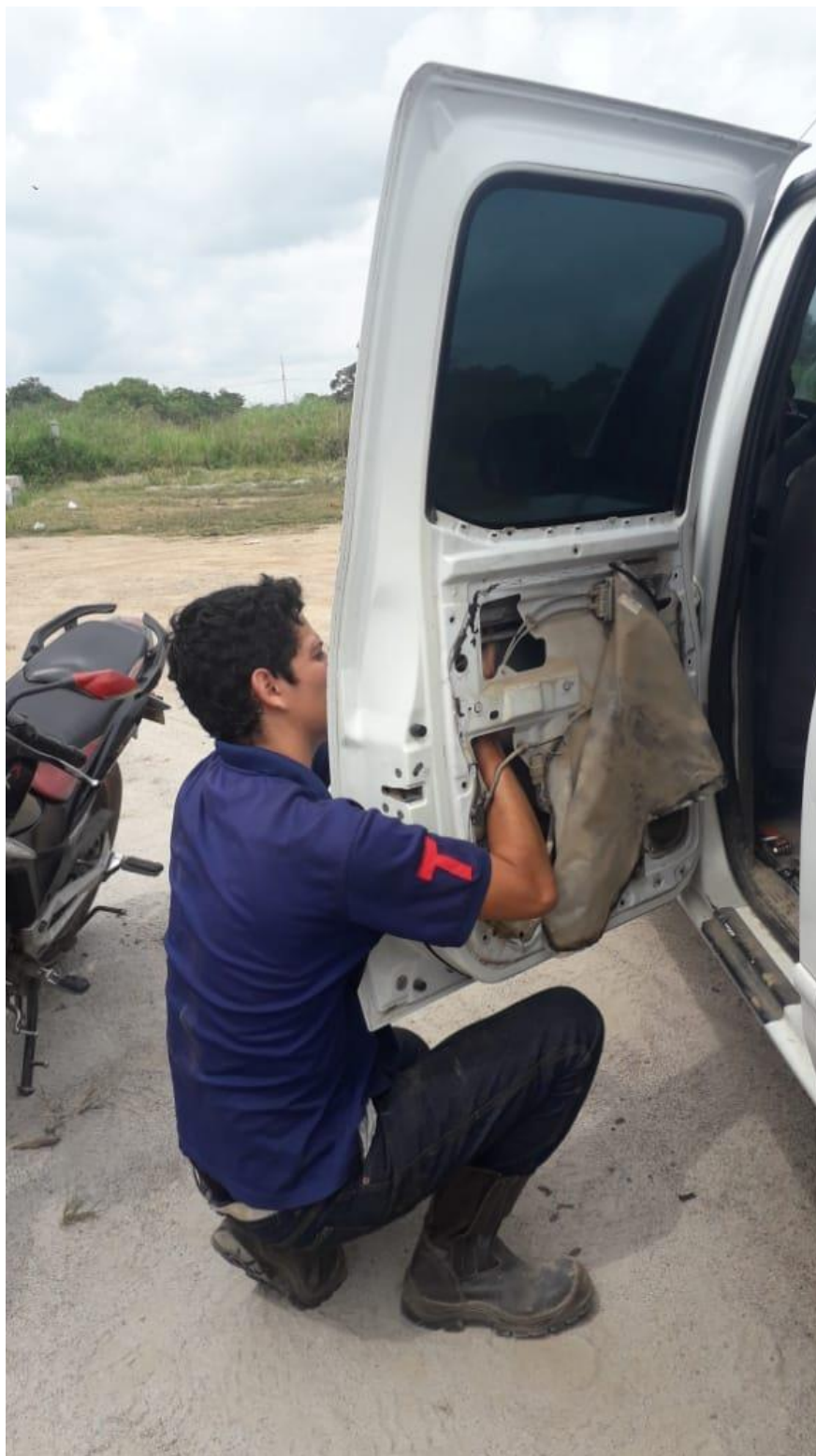
Figura 69. Cambio de chapa de puerta trasera izquierda de XWD361
