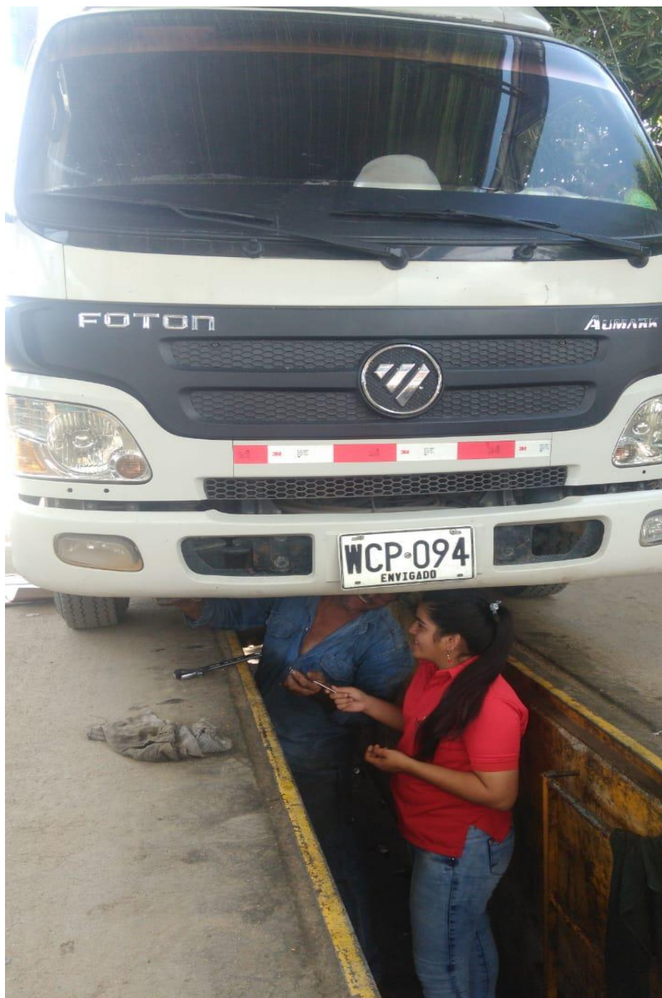
Figura 66. Cambio de filtros FLP-392, B173-S, P550588, DAJ576 y aceite 15W40 a turbo WCP094.
