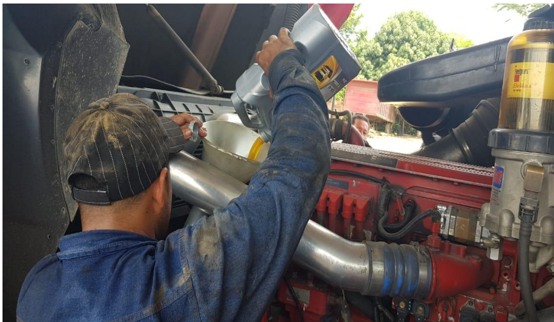
Figura 70. Cambio de aceite y kit de filtros tracto camión TJY909
