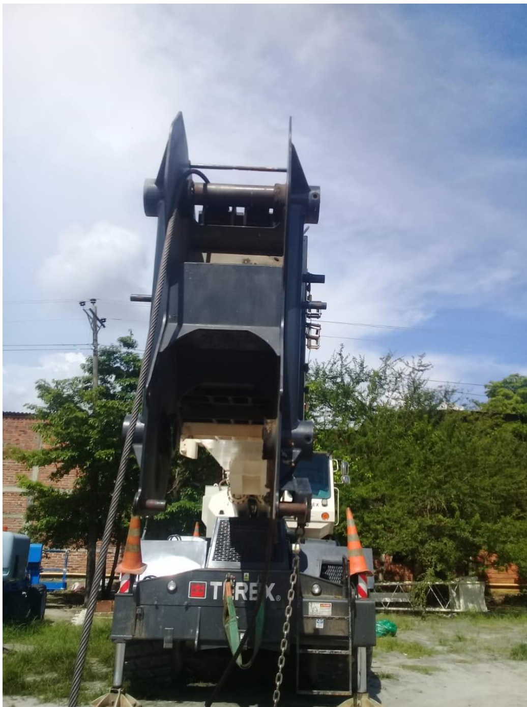
Figura 74. Cambio de poleas del cabezal grúa RT780
