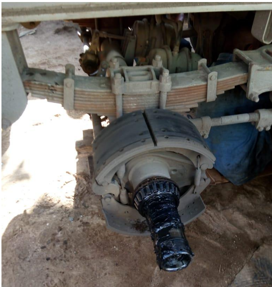
Figura 76. Cambio de bandas S50982
