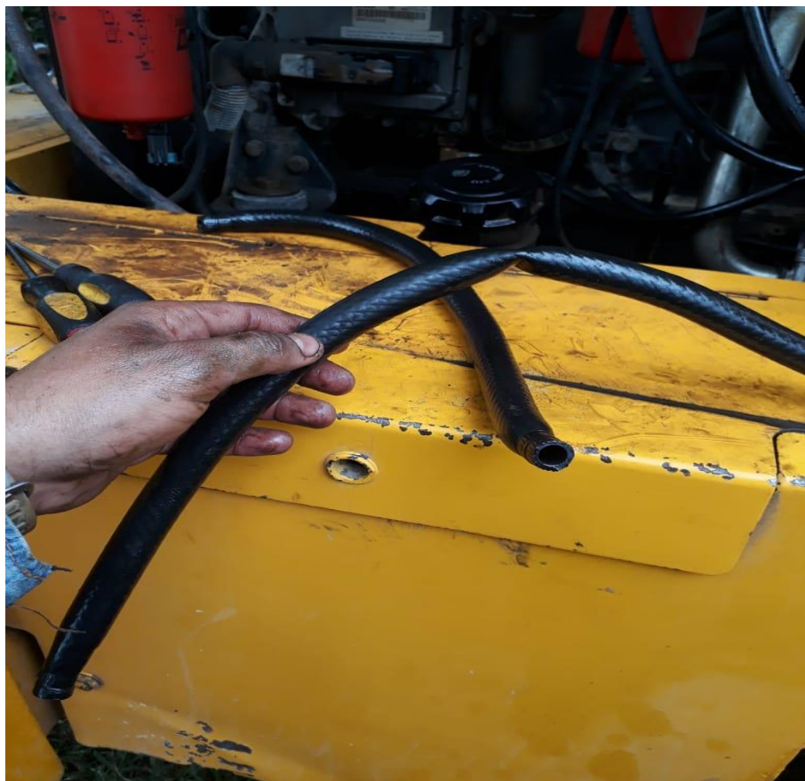
Figura 72. Cambio preventivo de mangueras W190C
