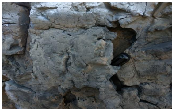
Figura 17. Separación por corte en banda de rodado
