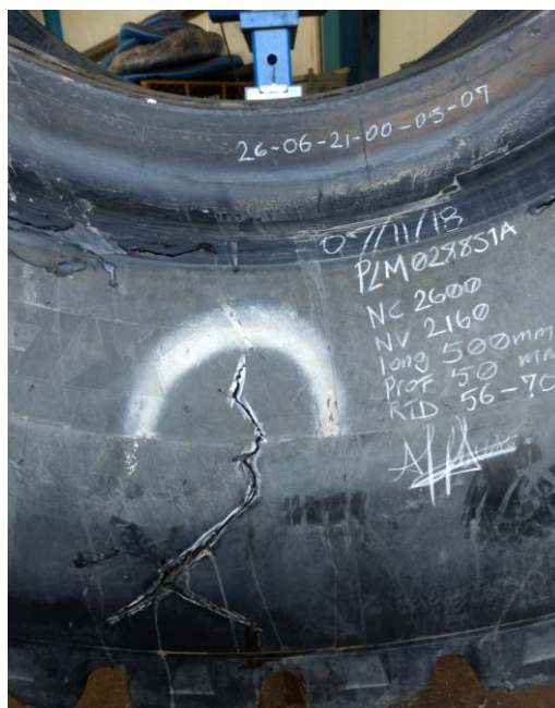
Figura 57. Marcado de llantas antes de empezar a ser reparadas
