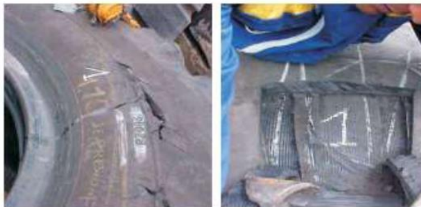
Figura 27. Separación mecánica en el costado
