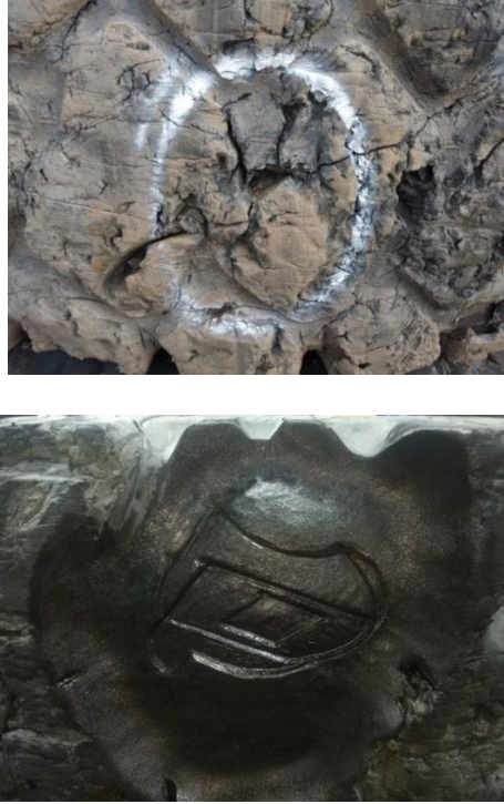
Figura 35. Corte pasante en la banda de rodado
