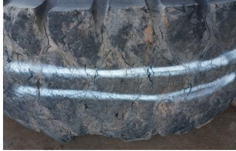
Figura 18. Desgaste total en banda de rodado
