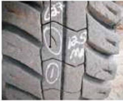
Figura 14. Daño no pasante en banda de rodado
