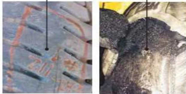
Figura 20. Separación por calor
