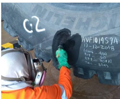
Figura 63. Aplicación del cemento parte exterior
