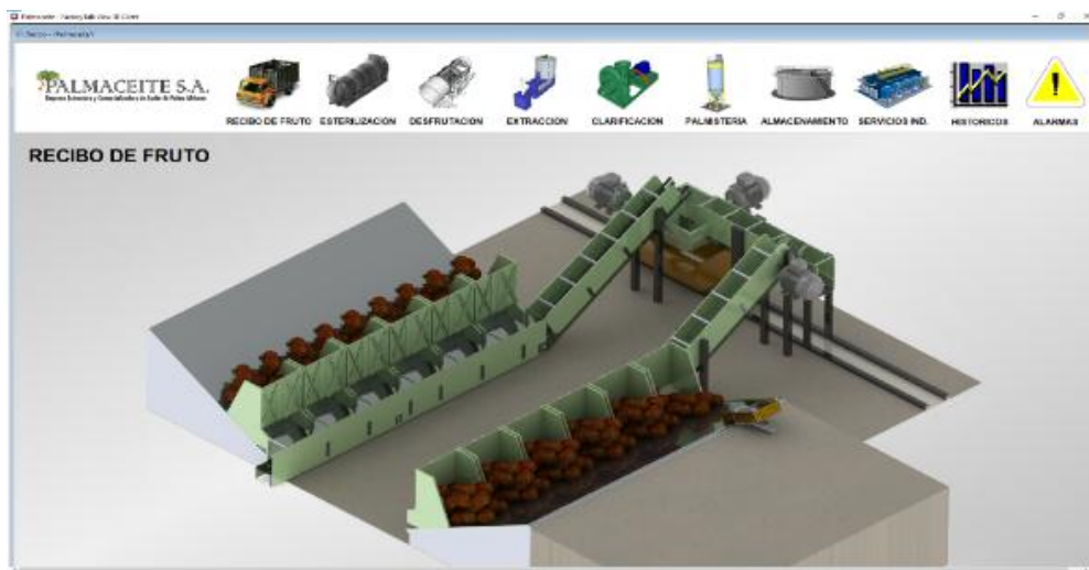
Figura 4: Sistema de Recepción de fruto Fuente: Supervisorio del proceso PALMACEITE
