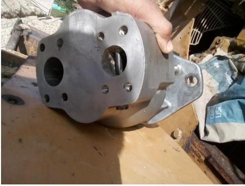
**Figura 13.** Bomba hidráulica del Bulldozer
