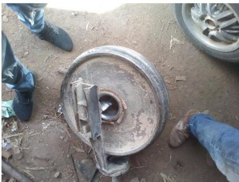
**Figura 19.** Rueda tensora dañada
