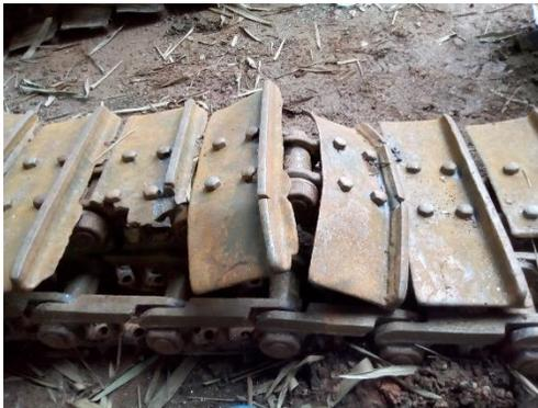
**Figura 20.** Cadenas con tejas dañadas
