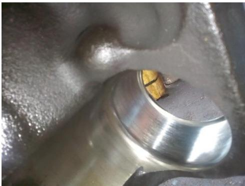
**Figura 16.** Desgaste del bloque 3306
