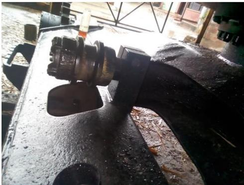
**Figura 28.** Rodamiento con su guía enderezada y reconstruida
