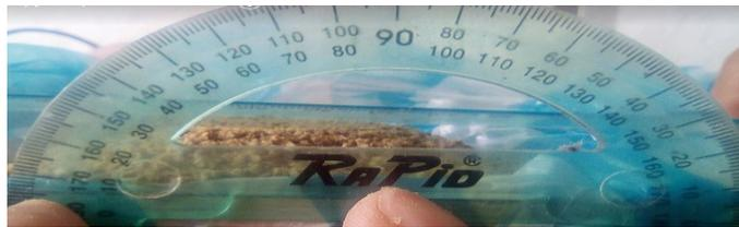
**Figura 42.** Medida con transportador y regla del ángulo de reposo del concentrado.
