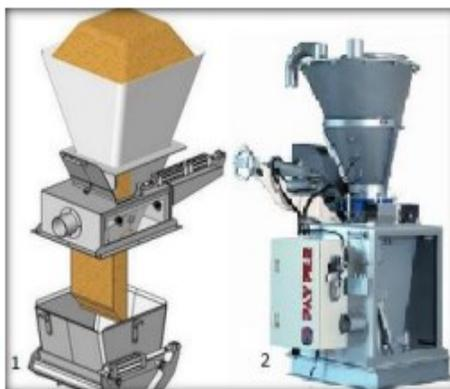
**Figura 16.** Máquina dosificadora mediante dosificación por gravedad.
