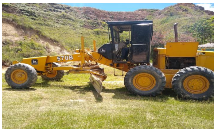
Figura 8. Motoniveladora JOHN DEERE 570B. Fuente: Autor (2019).
