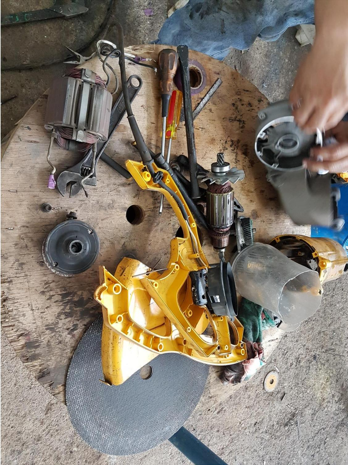
**Figura 22. Mantenimiento y limpieza de tronzadora de metal**
