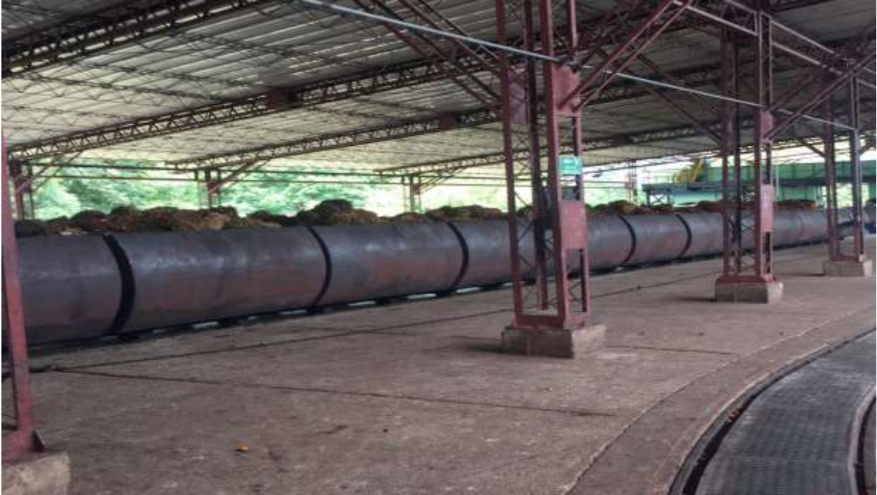
Acá se puede apreciar las vagonetas con el fruto, los cuales son llevados a la parte del autoclave Fuente Pasante
