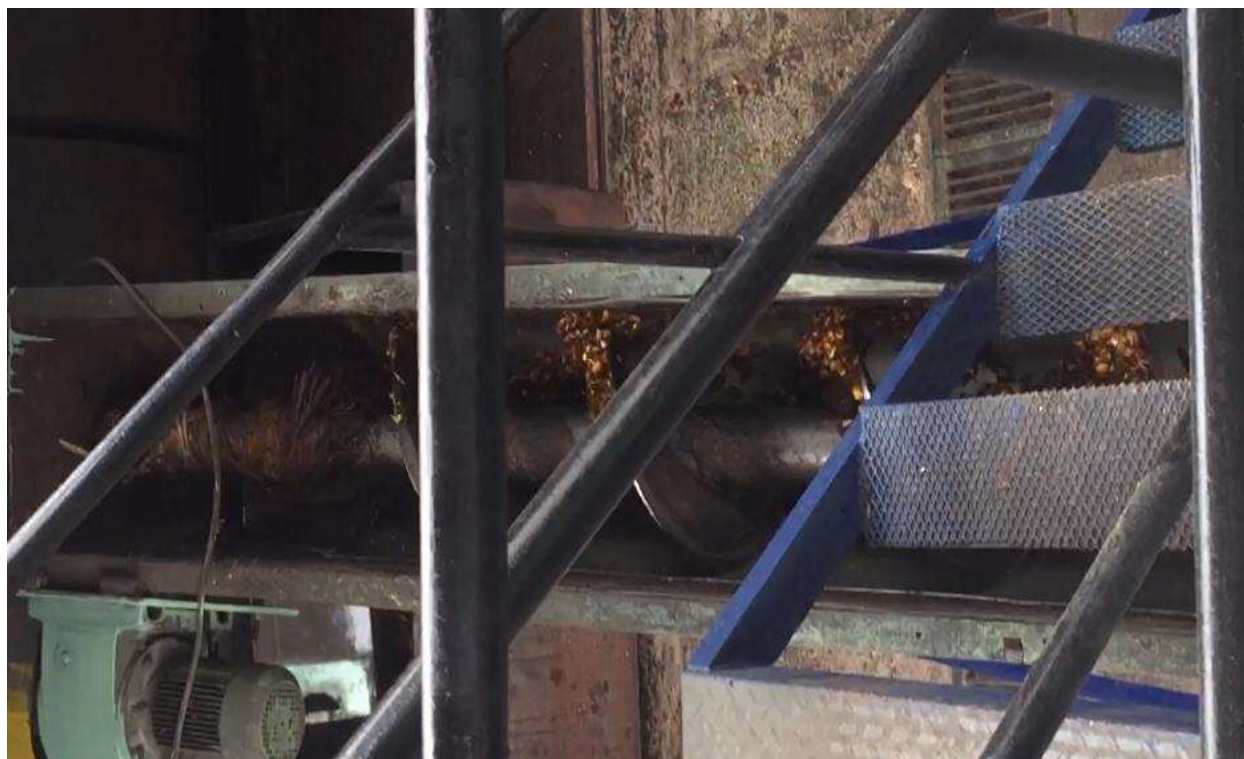
Por otro lado acá vemos que el fruto es transportado a la parte del digestor Fuente Pasante
