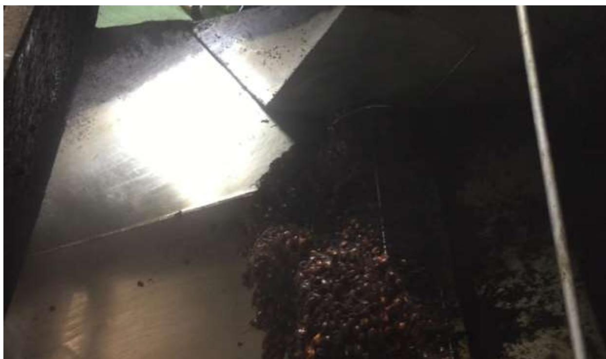
Acá el fruto ingresa al proceso de digestor, es acá donde se encuentra un eje vertical con tres brazos que se encargará de girar lentamente el fruto siendo macerado preparándolo así para la parte del prensado Fuente Pasante
