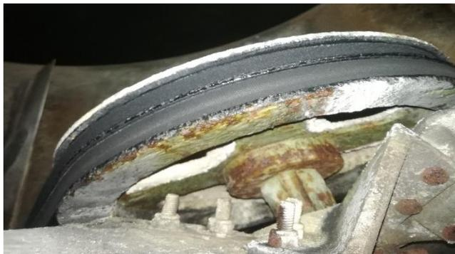
*Figura 30.* Sistema de transmisión por correa del motor ventilador 2 del acopio localizado en la Pedregosa-Cesar
