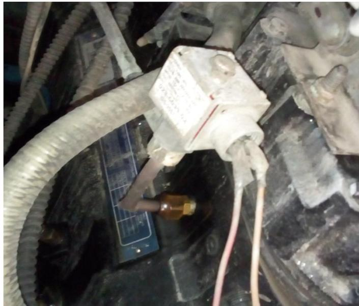
*Figura 11.* Válvula solenoide. Fuente. (Elaboración propia.2020)
