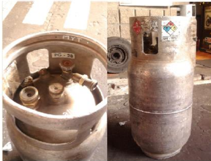
Figura 9. Cilindros de gas de montacargas de 40 lbs.
