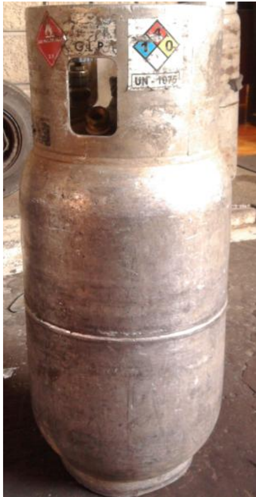
Figura 17. Cilindro de GLP para montacargas
