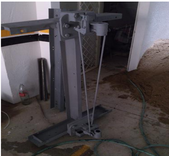
Fotografía 12. Segmento inferior del chasis de la cabina, con elementos de sujeción para el sistema de freno de cabina.
