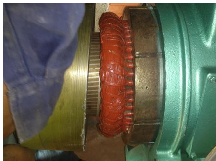
Fotografia 6. Ensamble del motor trifasico.
