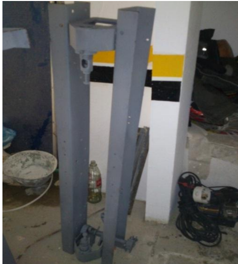
Fotografía 13. Segmento superior del chasis de la cabina.
