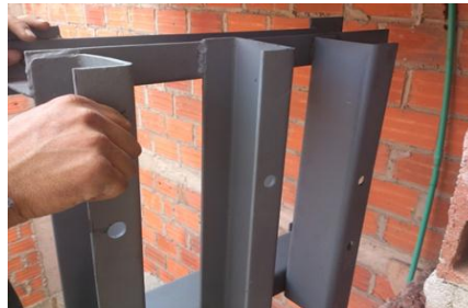
Fotografia 5. Bastidor para el anclaje del motor
