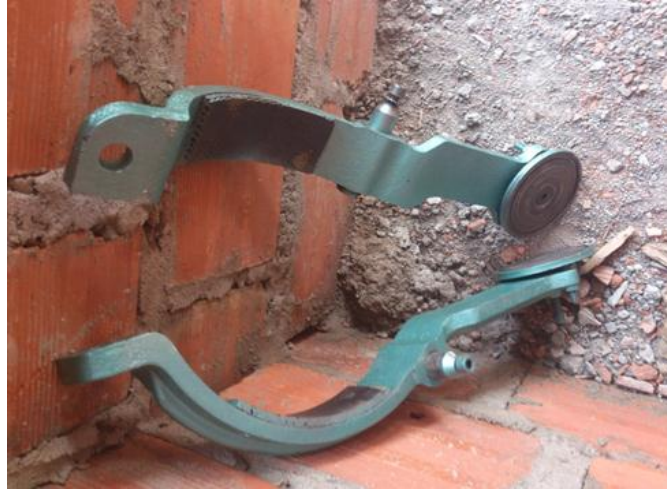
Fotografía 9. Zapatas para el sistema de frenos.
