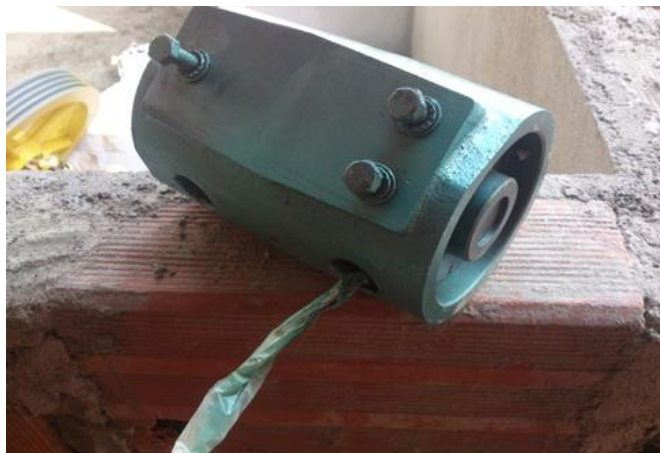
Fotografía 10. Motor de accionamiento de zapatas sistema de frenos.
