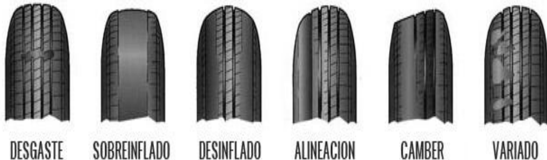
Figura 10. Causas del desgaste de llantas
