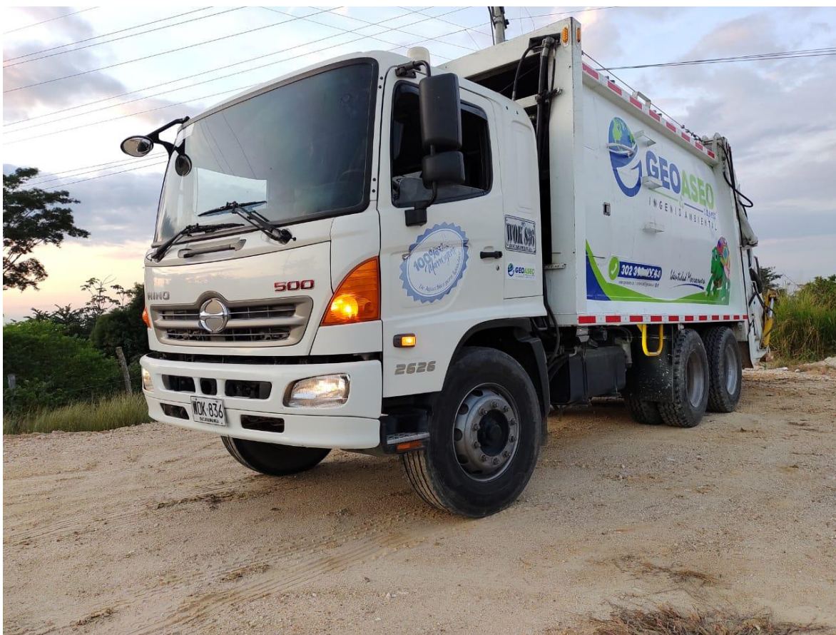
Figura 11. Camión tipo compactador para la recolección de residuos sólidos.
