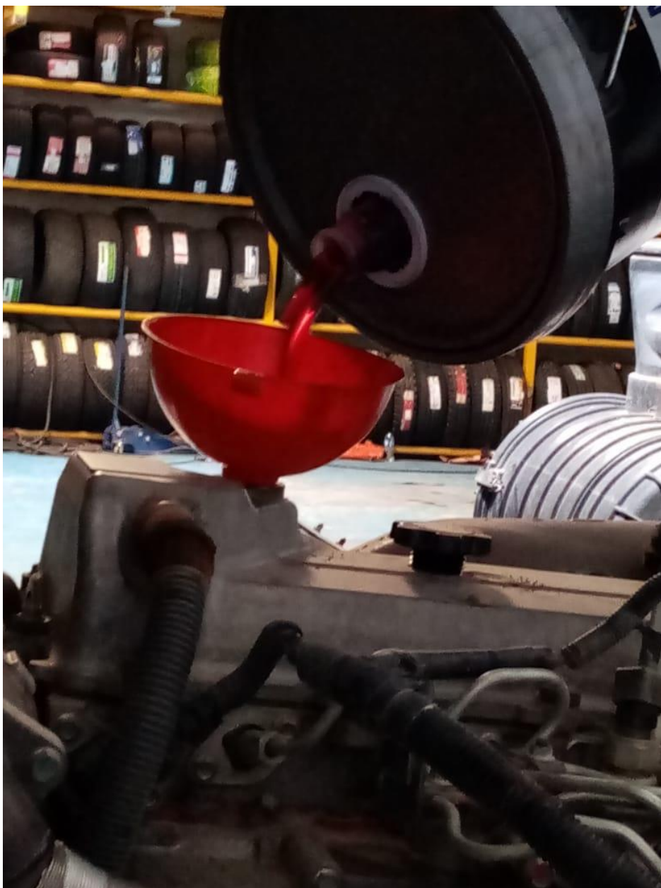
Figura 17. Cambio de aceite al camión tipo compactador
