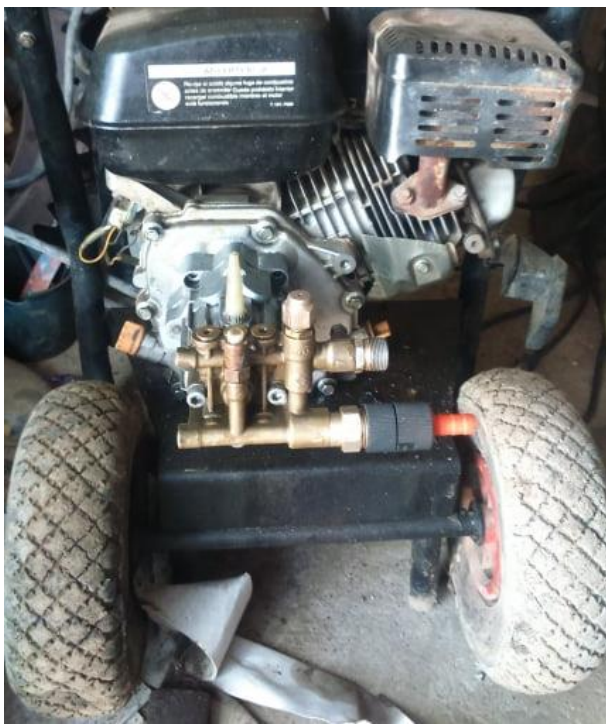
Figura 13. Hidrolavadora en funcionamiento. Fuente. Autor de la pasantía, 2020.
