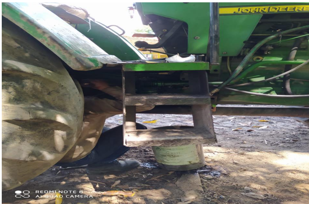
Figura 23. Ejecución de Mantenimientos en cambio de filtros y aceite. Fuente: Autor del proyecto.
