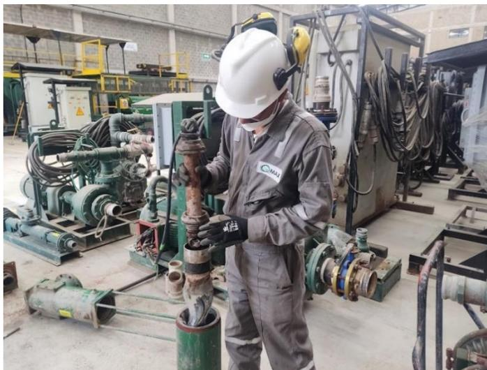
*Nota.* En la imagen se muestra el desmontaje del rotor de la bomba Moyno. (Tomada por el autor)
