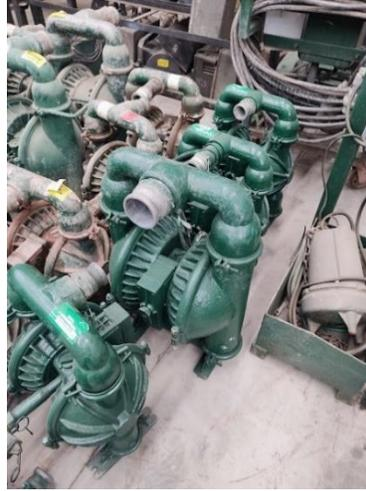
*Nota.* En la imagen se muestra un conjunto de bombas neumáticas. (Tomada por el autor)
