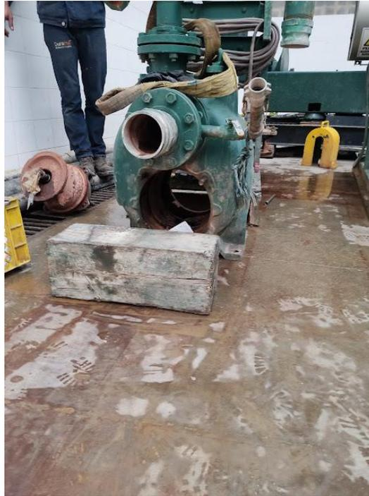
*Nota.* En la imagen se muestra la carcasa de una bomba Forte 4X4. (Tomada por el autor)
