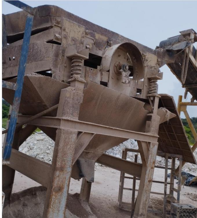
**3.1.2.1.4 Tolva.** Se suele colgar en la parte superior y el material se vierte en la tolva. Allí se almacena y, si es necesario, se abre el fondo del cono para liberar el contenido, como un embudo. A esta potencia se pueden sumar otras herramientas, que pueden triturar, triturar, fundir e incluso clasificar materiales según sus propiedades y usos, por lo que las tolvas pueden tener otras funciones además del almacenamiento y la medición cuantitativa.
