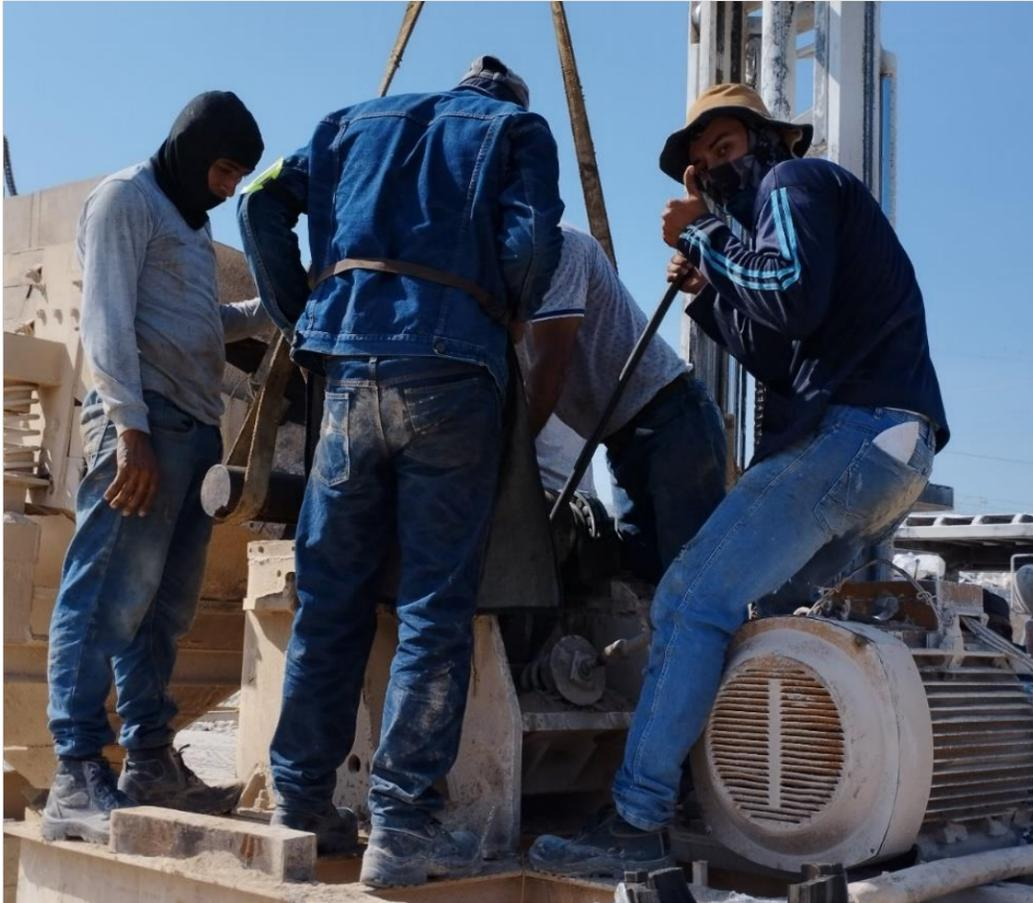
**Nota:** Ejecución de mantenimiento a las muelas de trituración, mediante acciones correctivas.
