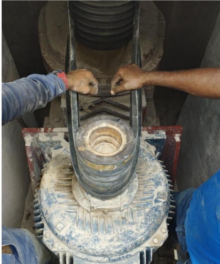
**Nota:** Ejecución de mantenimiento en correas del motor, las cuales tienden a calentarse.
