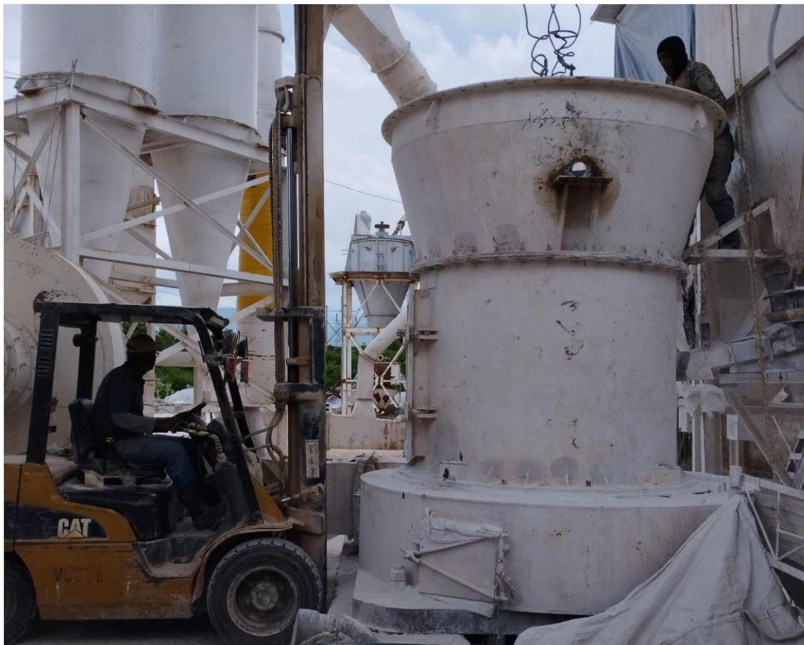
**Nota:** Ejecución de mantenimiento en cabezote superior del molino, para corregir desgaste del plato.
