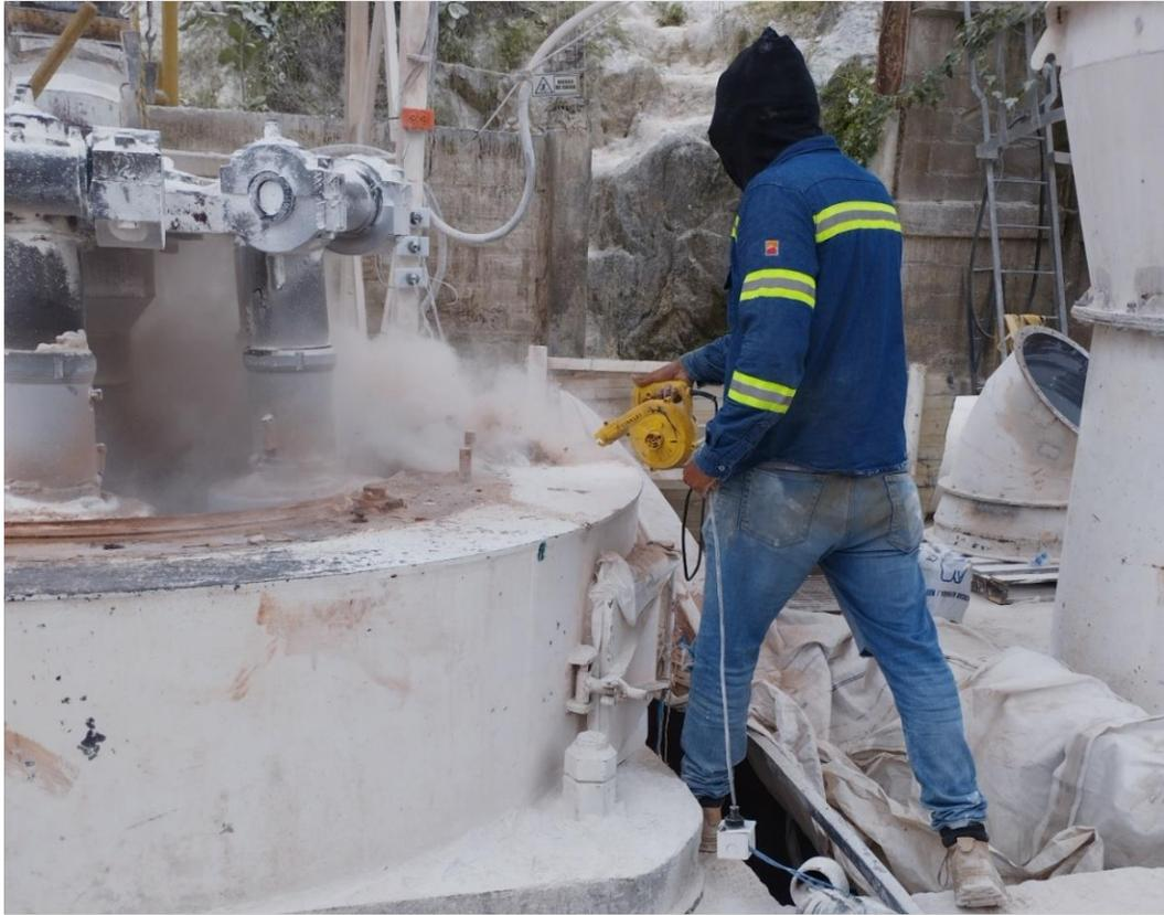
**Nota:** Cambio del plato central del molino para cambiar las masas, buje y anillo principal.
