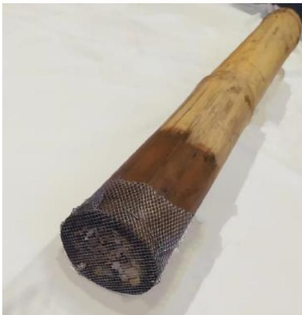
*Nota.* Diseño de la instalación de un módulo filtrante de aguas lluvias utilizando guadua, gravas, arenas y carbón activo, Bautista, 2020. Obra de dominio público con fines no comerciales CC-BY-NC.
