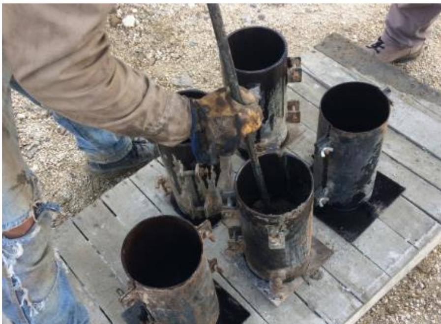
**Figura 17. Apisonamiento del concreto en 3 capas iguales, 25 golpes por capa, NTC 550.**
