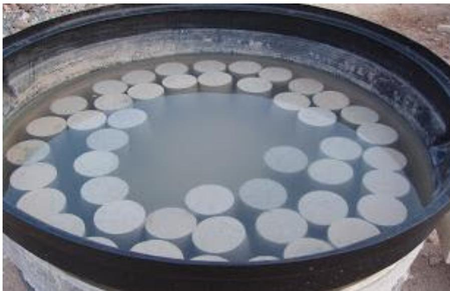
**Figura 20. Curado de cilindros de concreto, cumplimiento NTC 550.**
