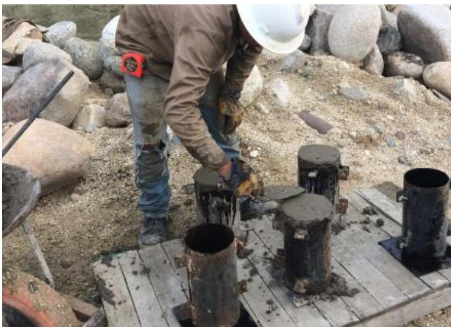
**Figura 19. Nivelado de superficie del cilindro, NTC 550.**
