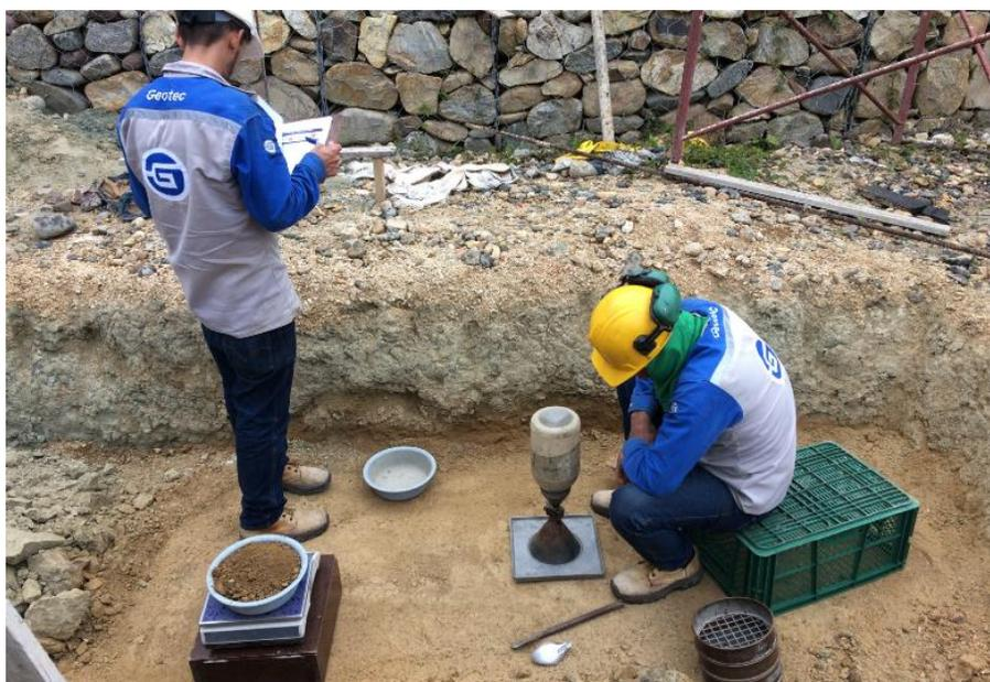
**Figura 25. Densidad en campo, ubicación del cono de arena y peso de material extraído.**
