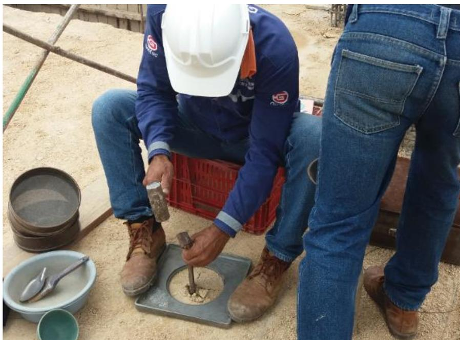
**Figura 24. Densidad en campo, extracción del material.**
