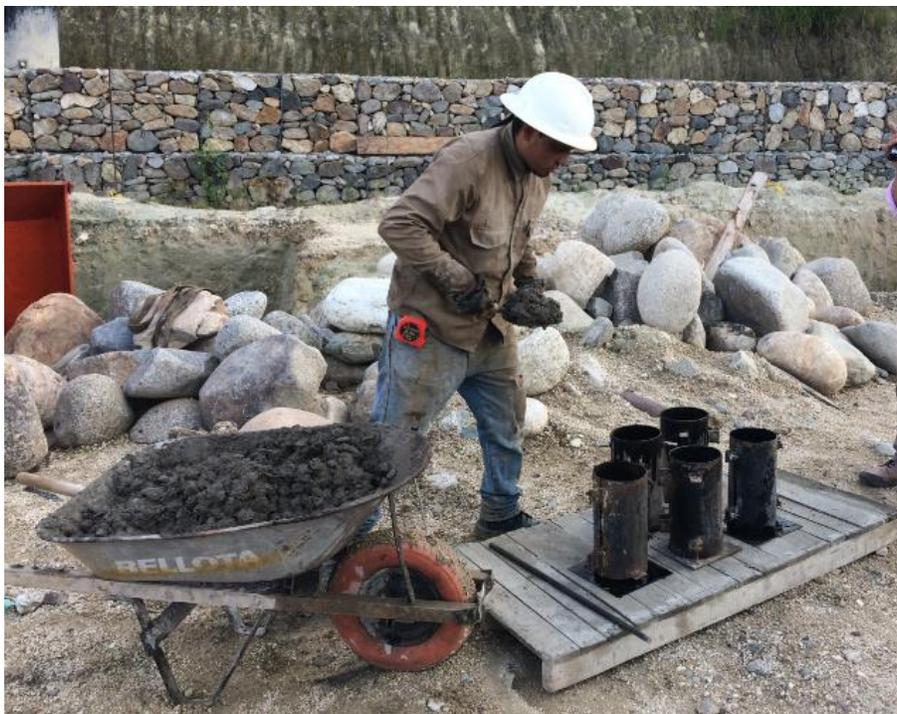
**Figura 16. Instalación de la mezcla en molde de cilindros.**
