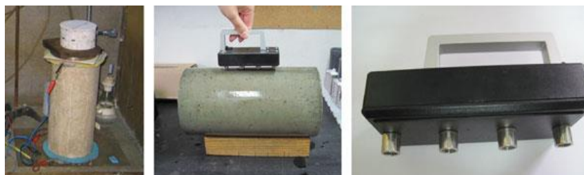
Figura 15 Medidor de Resistividad eléctrica
