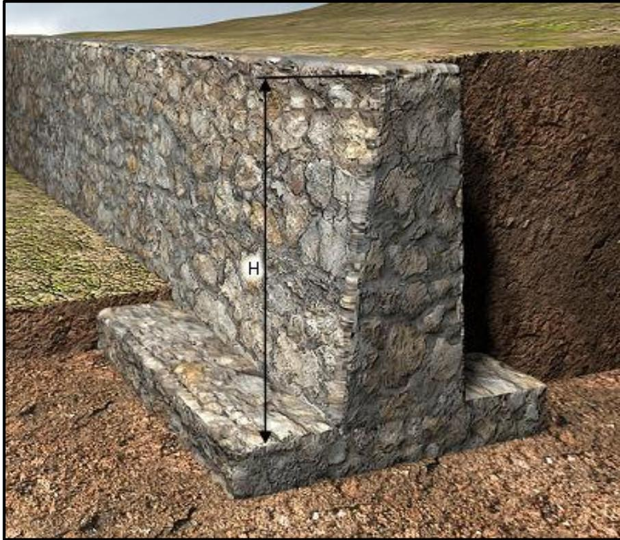
*Ilustración 17.* Esquema de muro de concreto ciclópeo culminado
