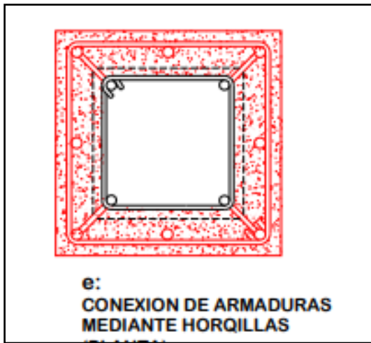
Ilustración 23, Conexión de armaduras mediante Horquillas.
