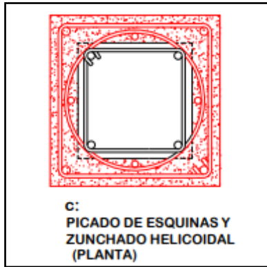
Ilustración 22. Refuerzo con zunchado helicoidal.
