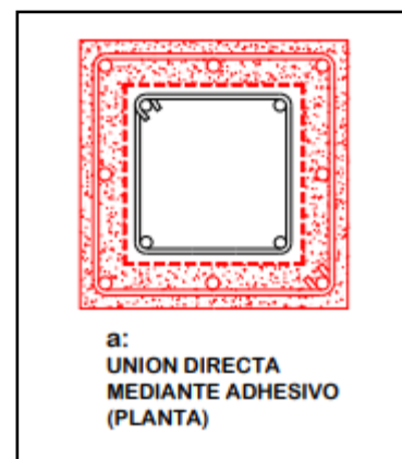
Ilustración 21. Unión directa mediante adhesivo.
