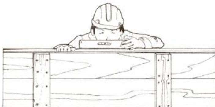
Figura 46. Verificar forma, medidas, niveles y estabilidad
