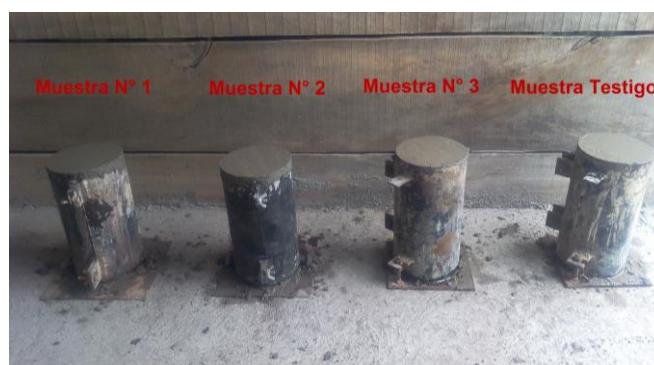
Figura 34. Cilindros para ensayo de resistencia del concreto. Fuente: Autores
