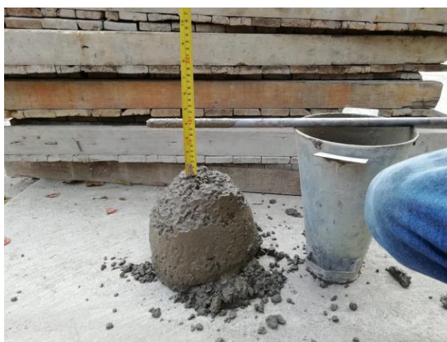
Figura 33. Ensayo de asentamiento.
