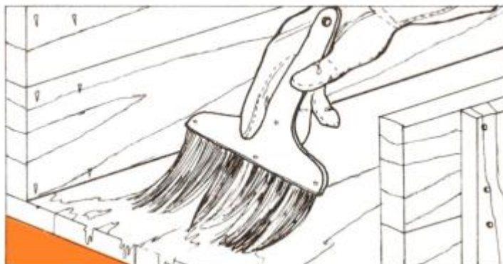
Figura 44. Aplicar desmoldante Fuente: Escobar, J. E., Prieto Paz, J. M., & González, M. (1986). Armado de encofrados en madera.
