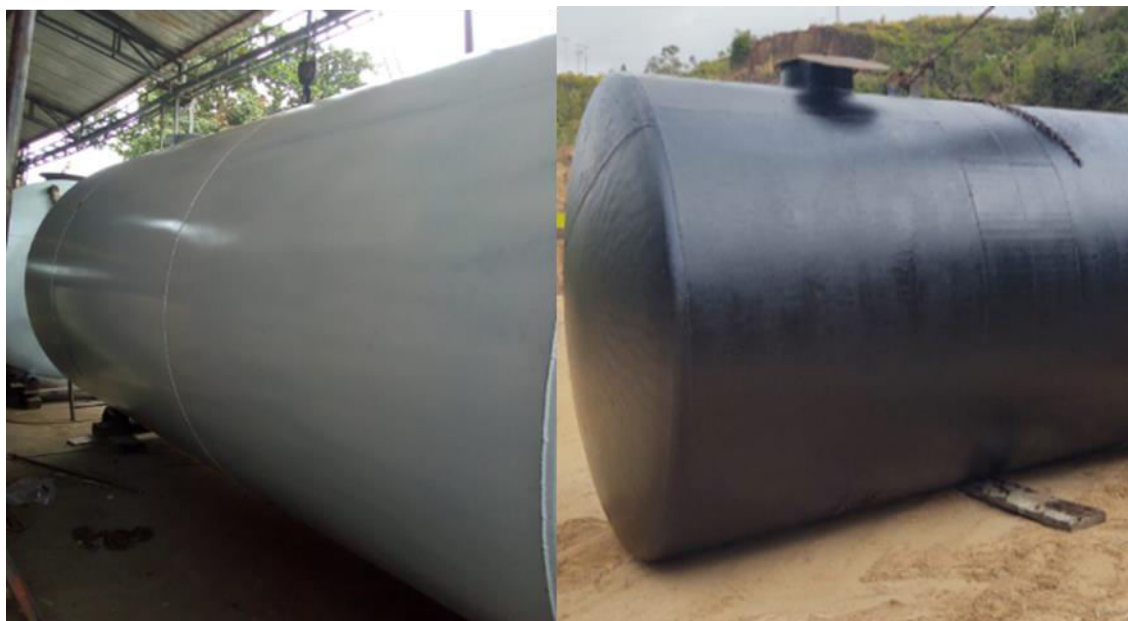
Figura 34. Protección de los tanques almacenadores. Fuente. Autores del proyecto.
