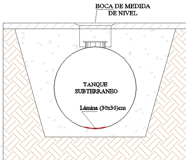
Figura 31. Refuerzo del piso interior del tanque. Fuente. Autores del proyecto.
