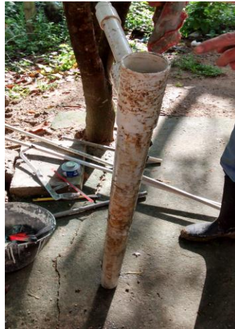
Foto 25. Área afectada en la tubería de 2”.
