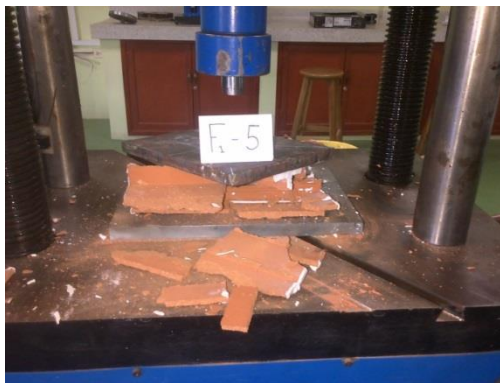
Fotografía 19. Falla a compresión de la unidad de mampostería.
