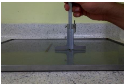
Fotografía 38. Medición de la profundidad del agua.
