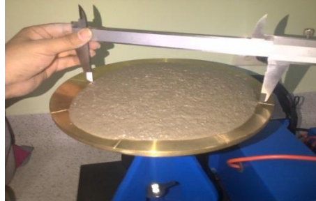
Fotografía 47. Medición del diámetro de la muestra.
