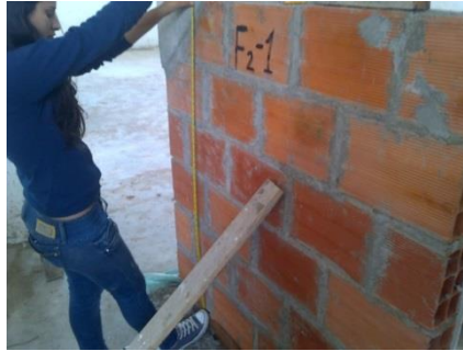
Fotografía 119. Medición de las dimensiones del murete no reforzado
