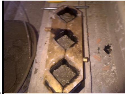
Fotografía 51. Primera fase de llenado de la formaleta.
