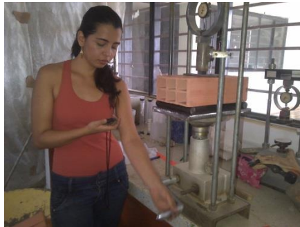
Fotografía 26. Control de la velocidad en la aplicación de carga al espécimen.
