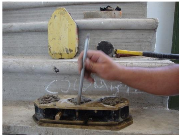
Fotografía 54. Apisonamiento de la segunda capa de mortero.
