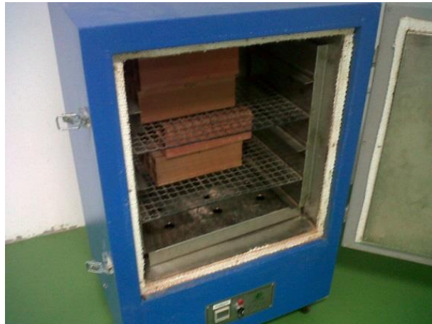
Fotografía 5. Secado de las piezas de mampostería en el horno mufla
