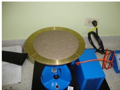
Fotografía 89. Ensayo de mesa de flujo.
