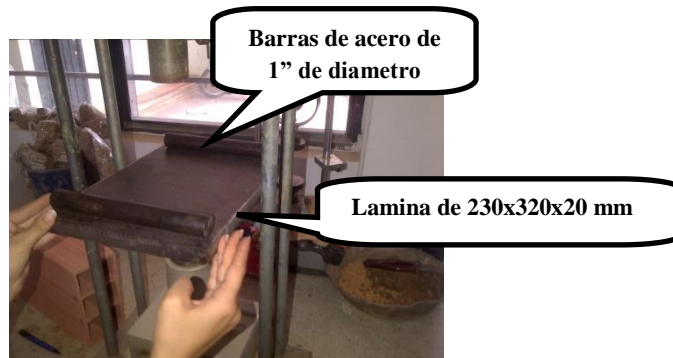
Fotografía 23. Barras de acero colocadas encima de la lámina base.
