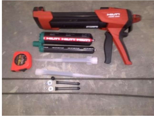
Fotografía 99. Anclaje Hilti HIT-HY 70.
