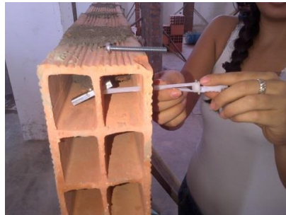
Fotografía 101. Introducción del elemento metálico en el agujero.
