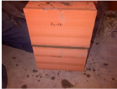
Fotografía 66. Construcción de prismas.
