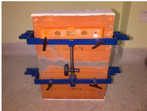
Fotografía 79. Nivelación de los soportes.
