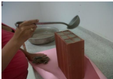
Fotografía 133. Llenado de los núcleos del bloque.
