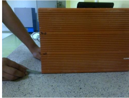
Fotografía 130. Medición de la superficie convexa
