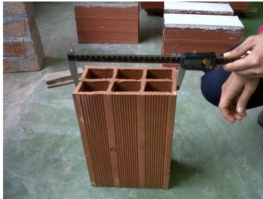
Fotografía 2. Medición de la altura de las unidades de mampostería.
