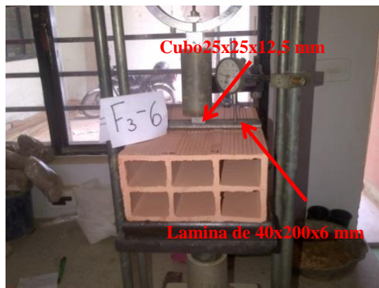
Fotografía 25. Aplicación de la carga al espécimen.
