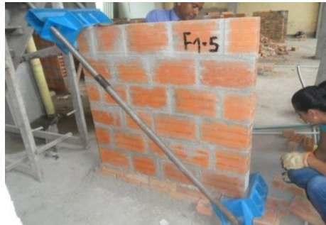
Fotografía 120. Instalación del equipo para el ensayo de tracción diagonal en muros no reforzados.
