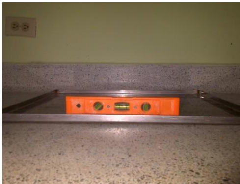
Fotografía 35. Nivelación de la bandeja
