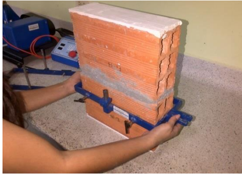
Fotografía 78. Instalacion de los soportes en el prismas.
