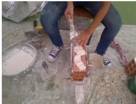
Fotografía 13. Vertido de la mezcla en el espécimen
