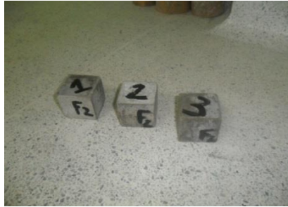
Fotografía 88. Cubos de mortero de pega.
