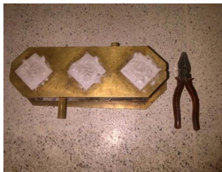
Fotografía 57. Fraguado de los cubos de mortero.
