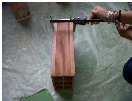
Fotografía 4. Medición del ancho de las unidades de mampostería.
