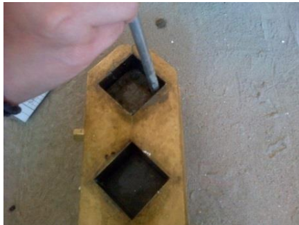
Fotografía 52. Apisonamiento de la capa de mortero.
