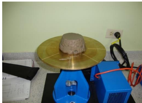
Fotografía 46. Muestra al finalizar la prueba de la mesa de flujo
