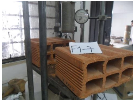
Fotografía 27. Falla después de aplicar carga al espécimen.
