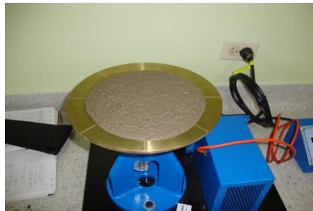
Fotografía 46. Muestra al finalizar la prueba de la mesa de flujo
