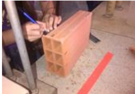
Fotografía 24. Medición de los 12,5 mm en la unidad.
