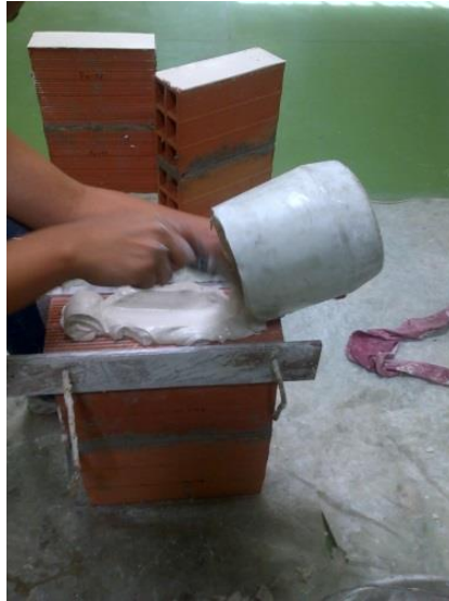
Fotografía 74. Vertido de la mezcla en el espécimen.
