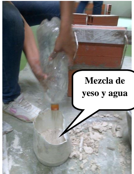
Fotografía 72. Preparación de la mezcla para el refrentado.
