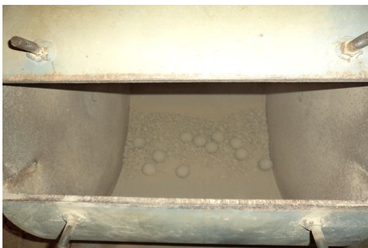
Fotografía 77. Material en la máquina de los ángeles
