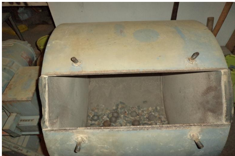
Fotografía 76. Material en la máquina de los ángeles
