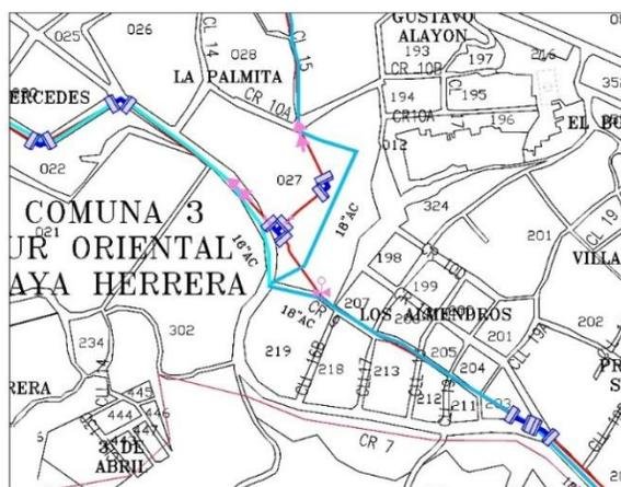
Figura 82. Corrección del trazado zona denominado San Cayetano bifurcación en tubería. Fuente: Pasante del proyecto 18" de A.C.
