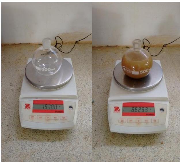
Figura 6. Determinación de la gravedad específica del agregado fino.
