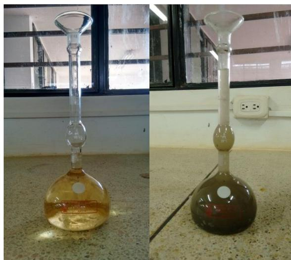
Figura 8. Ensayo para determinar la densidad del cemento hidráulico.
