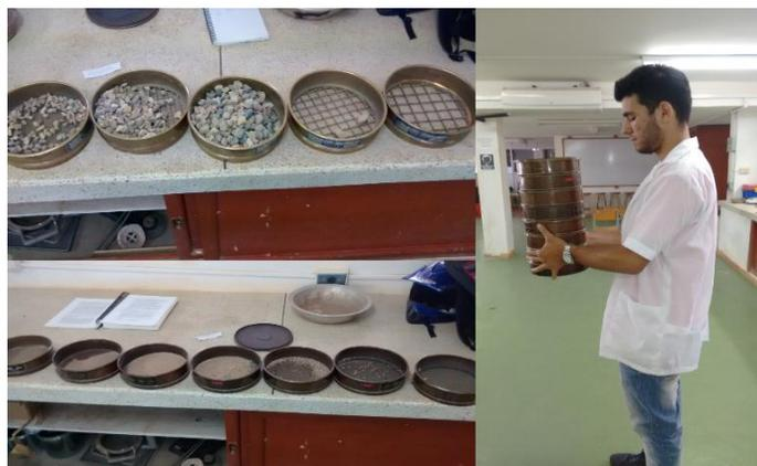
Figura 4. Análisis granulométrico de los agregados.
