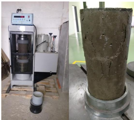
Figura 24. Determinación de la resistencia de los cilindros de concreto.
