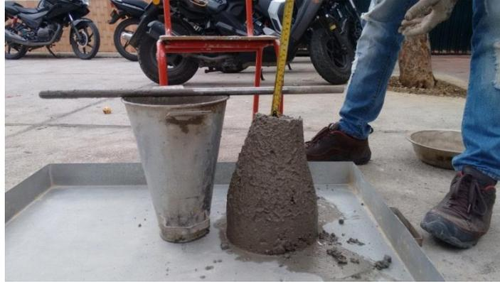
Figura 14. Determinación del asentamiento de la mezcla de concreto.
