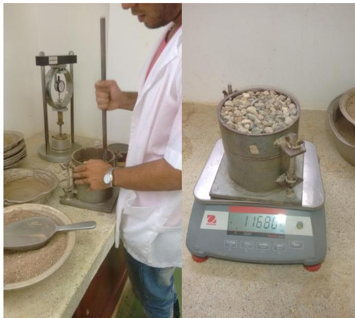
Figura 3. Ensayo para determinar la masa unitaria compacta.
