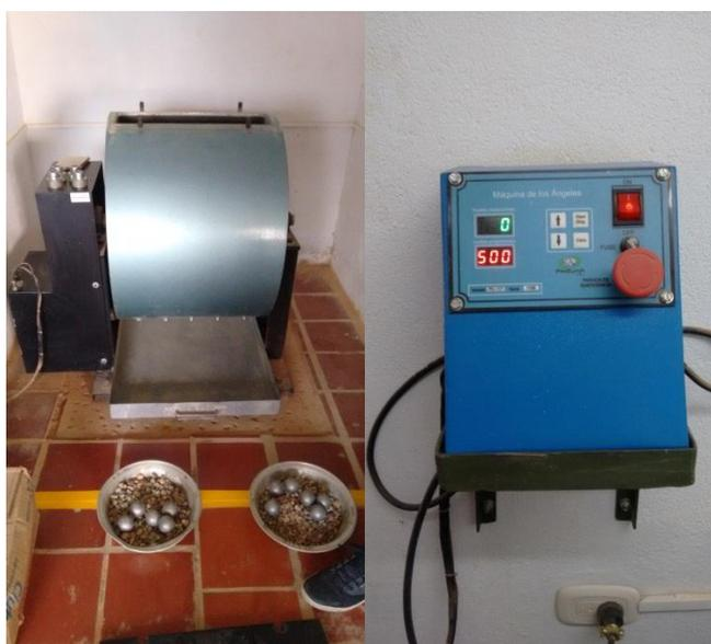
Figura 12. Determinación de la resistencia al desgaste del agregado grueso.
