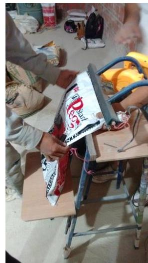
Figura 19. Sellado y extracción de aire.
