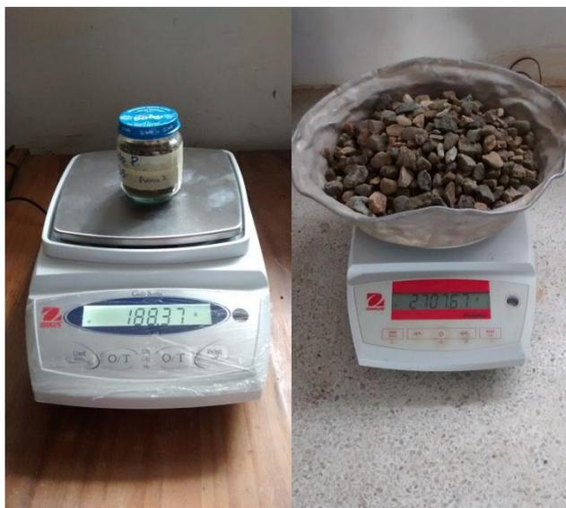
Figura 1. Determinación del contenido de humedad para agregados.
