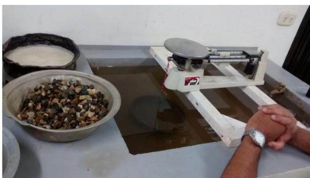
Figura 7. Determinación de la gravedad específica del agregado grueso.
