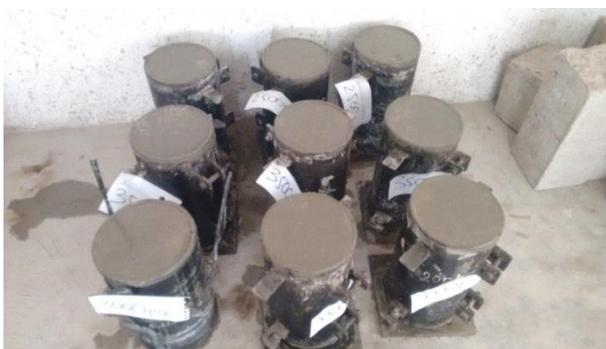
Figura 21. Cilindros de concreto.
