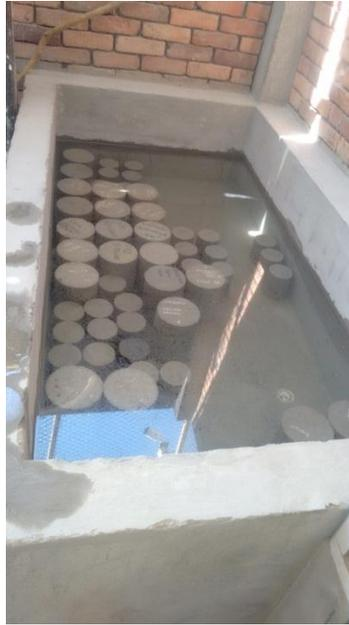
Figura 23. Proceso de curado de muestras de concreto y mortero.
