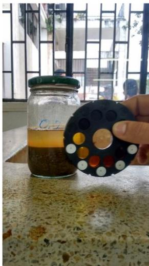
Figura 11. Determinación del contenido de materia orgánica de agregado fino.
