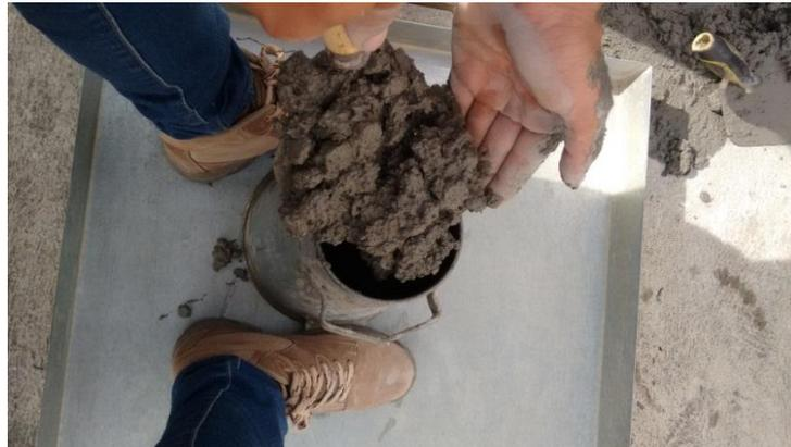
Figura 13. Proceso de llenado del molde para medir el asentamiento.
