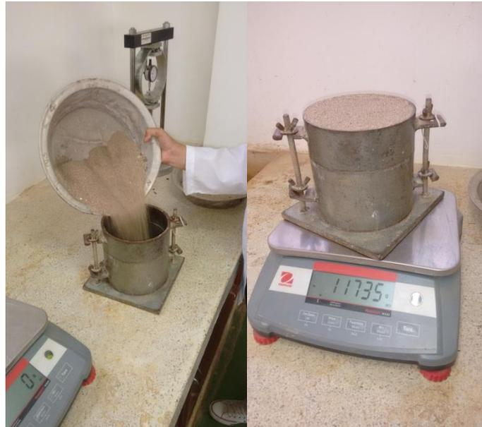
Figura 2. Ensayo de masa unitaria suelta.
