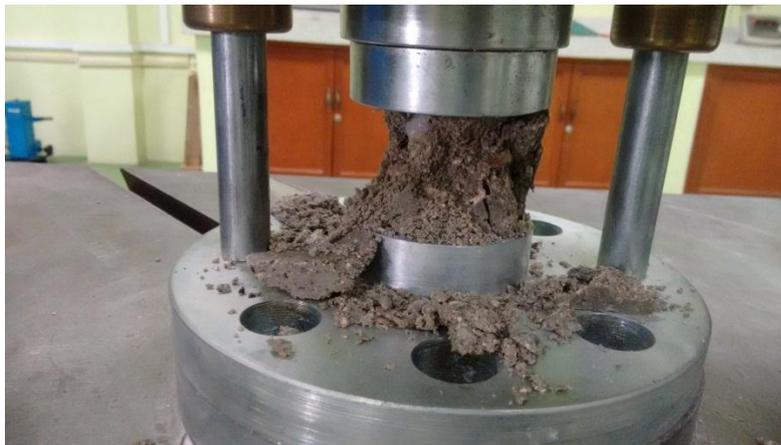
Figura 25. Resistencia a la compresión de cubos de mortero.
