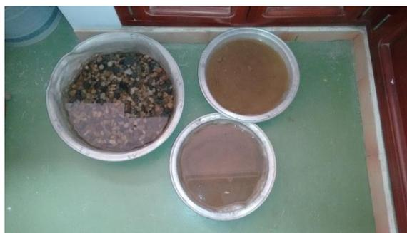
Figura 5. Saturación de agregados finos y gruesos con agua.
