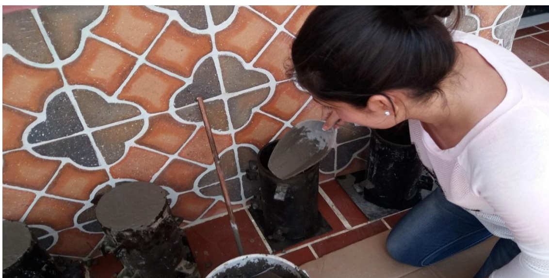
Ilustración 28 Vaciado de la mezcla
