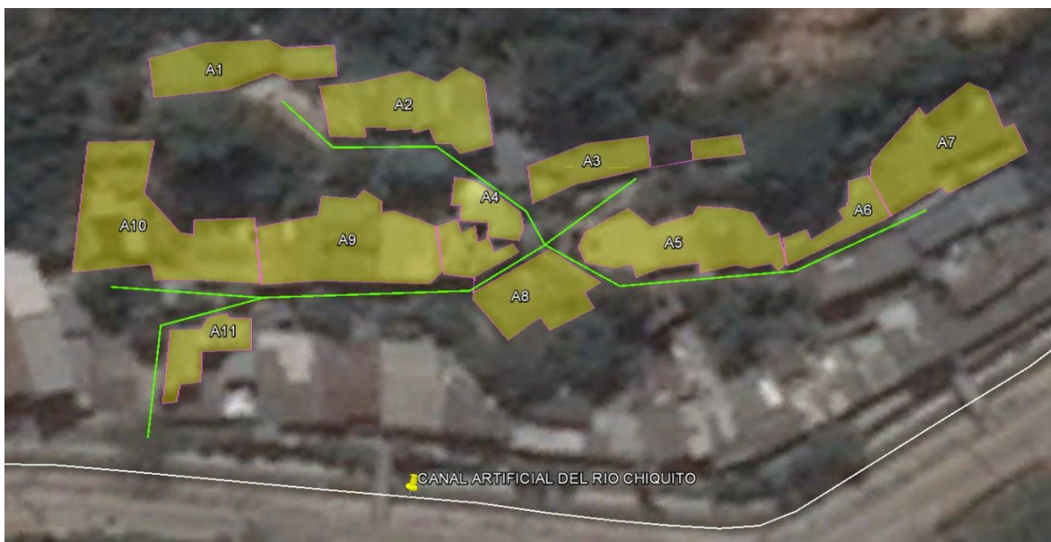
Figura 59. Áreas contribuyentes al sistema de alcantarillado residual.
