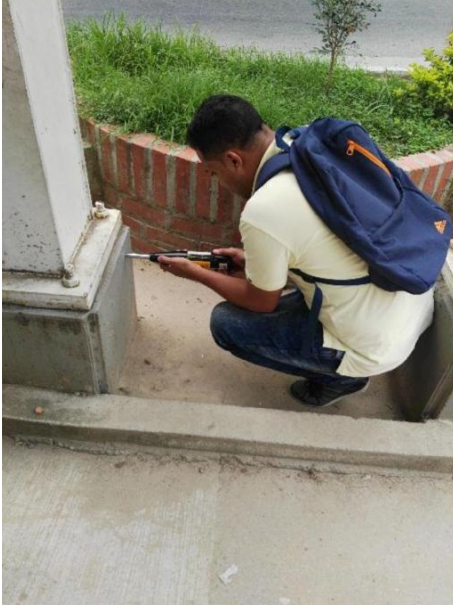
Figura 62. Ensayo de esclerometria. Fuente: Autores del proyecto.
