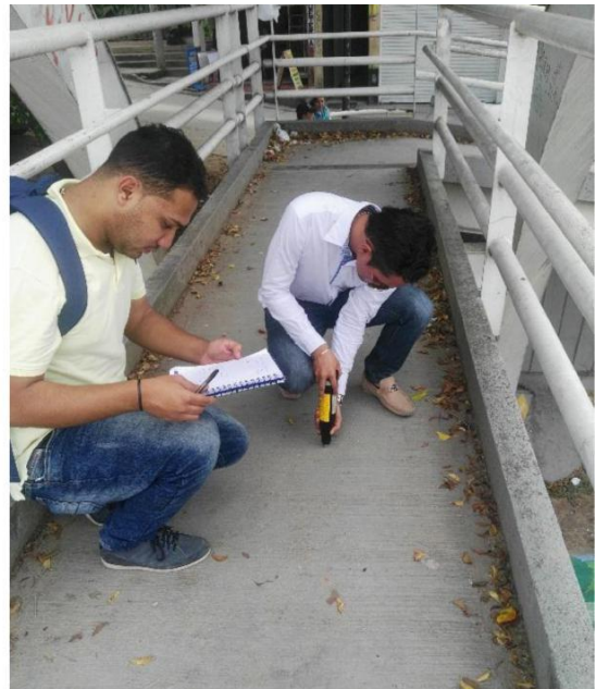
Figura 65. Toma de datos de esclerómetro. Fuente: Autores del proyecto.
