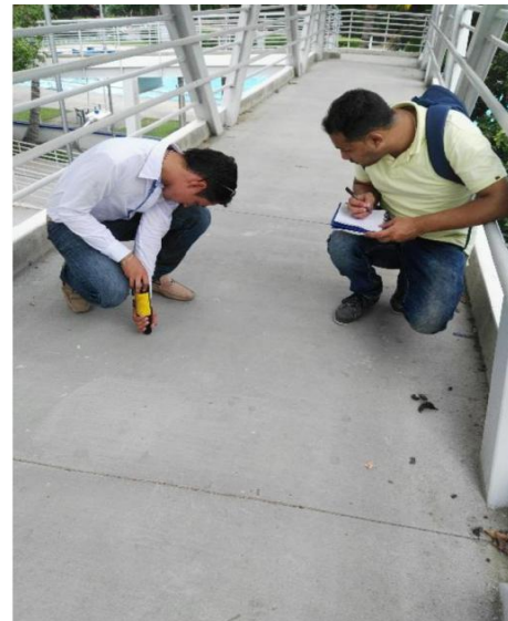
Figura 60. Esclerometría superficie losa Fuente: Autores del proyecto.
