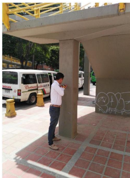
Figura 56. Prueba del esclerómetro. Fuente: Autores del proyecto.
