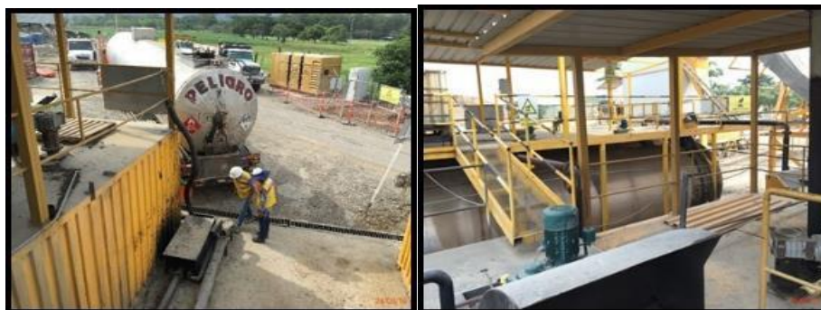
Fotografías 190 y 191. Entrega y almacenamiento de emulsión asfáltica.
