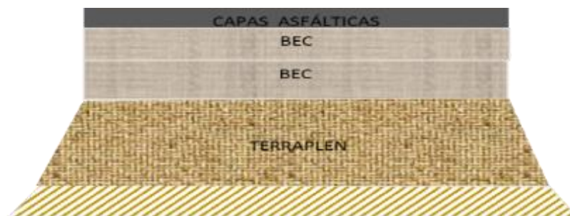
Figura 32. Sección construcción Nueva – Granulares estabilizados con cemento.
