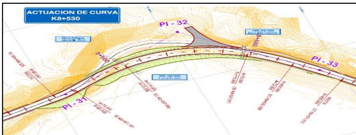
Figura 36. Modificación del trazado en la curva del PR 8+530.
