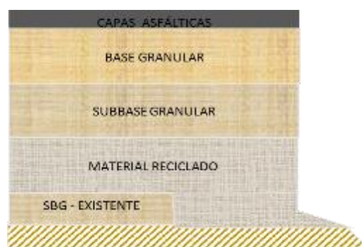
Figura 31. Sección condición 2. Sin aportación, capa continua.
