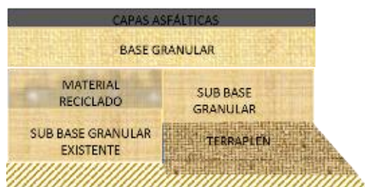
Figura 28. Sección condición 1. Aportación de la SBG existente.
