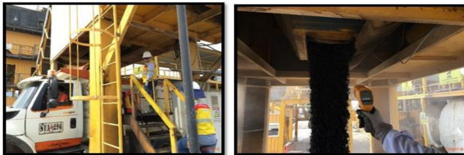
Fotografías 192 y 193. Verificación de la temperatura de salida del asfalto.
