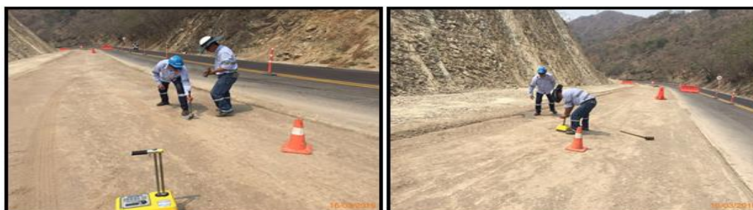
Fotografía 178 y 179. Toma de densidad y humedad sub-base granular entre los K20 + 970 – K21 + 060.
