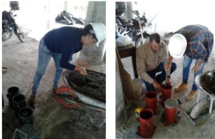
Figura 71. Realización de cilindros
