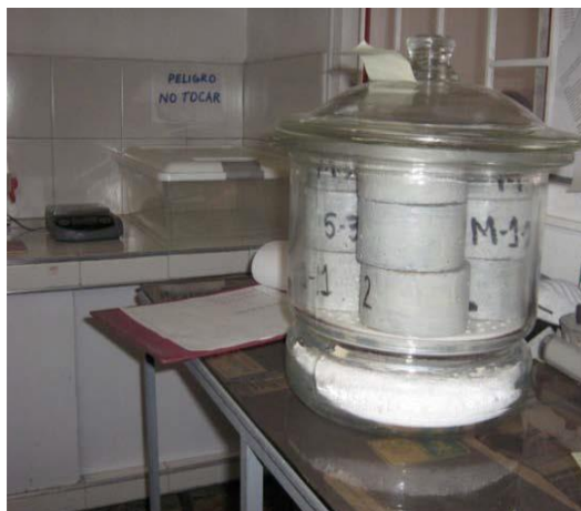
Figura 16. Montaje acorde con ASTM C 1585.
