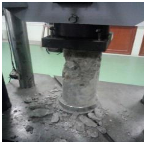
Figura 3. Ensayo resistencia a la compresión. Cilindro fallado.
