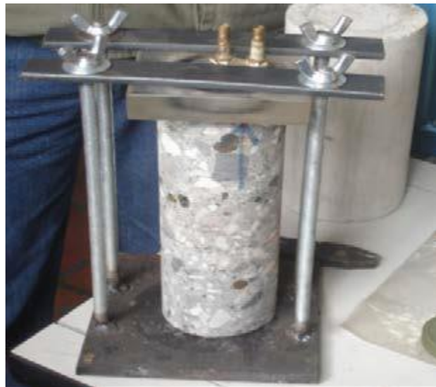
Figura 14. Montaje ensayo tasa de absorción superficial inicial
