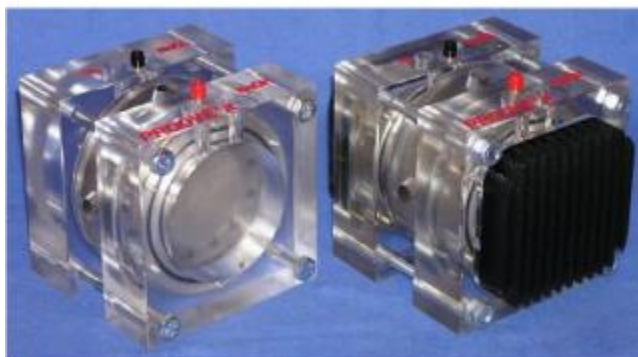
Figura 10. Montaje ensayo permeabilidad a cloruros,
