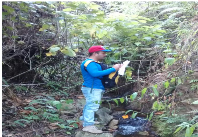
Foto 2. Aforo de la micro cuenca (decámetro, metro, bolas de icopor y cronometro)
