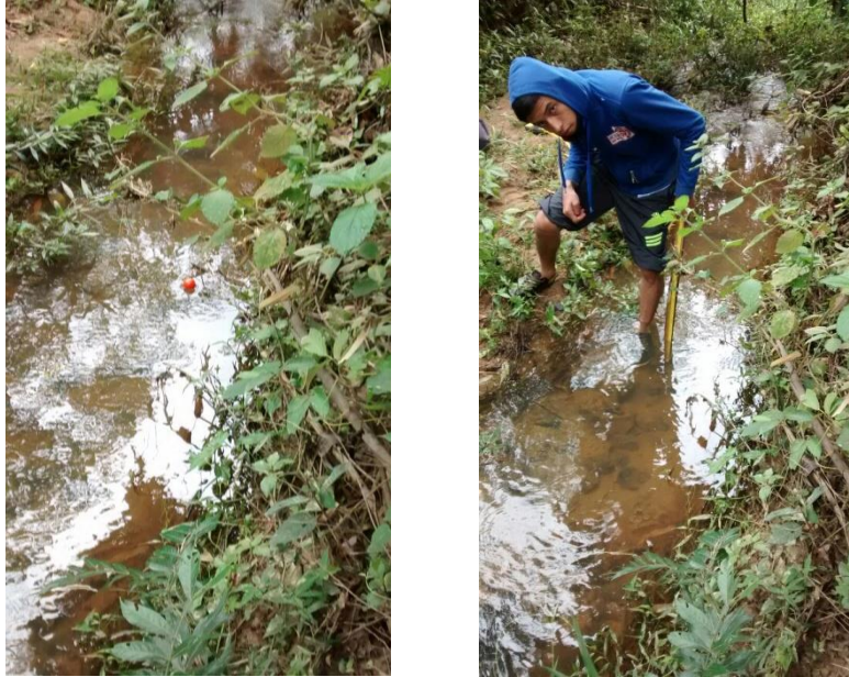
Figura 3. Aforo de la microcuenca (metro, bola de plástico, cronometro)
