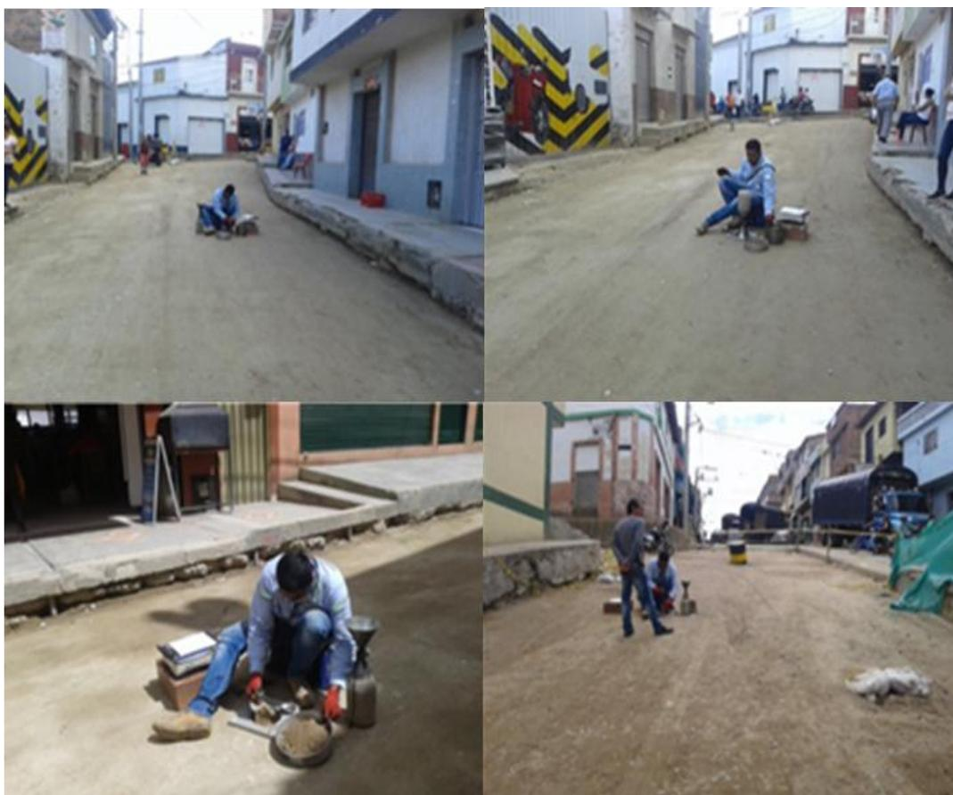
**Figura 41. Toma de Muestras para ensayos de Laboratorio.**
