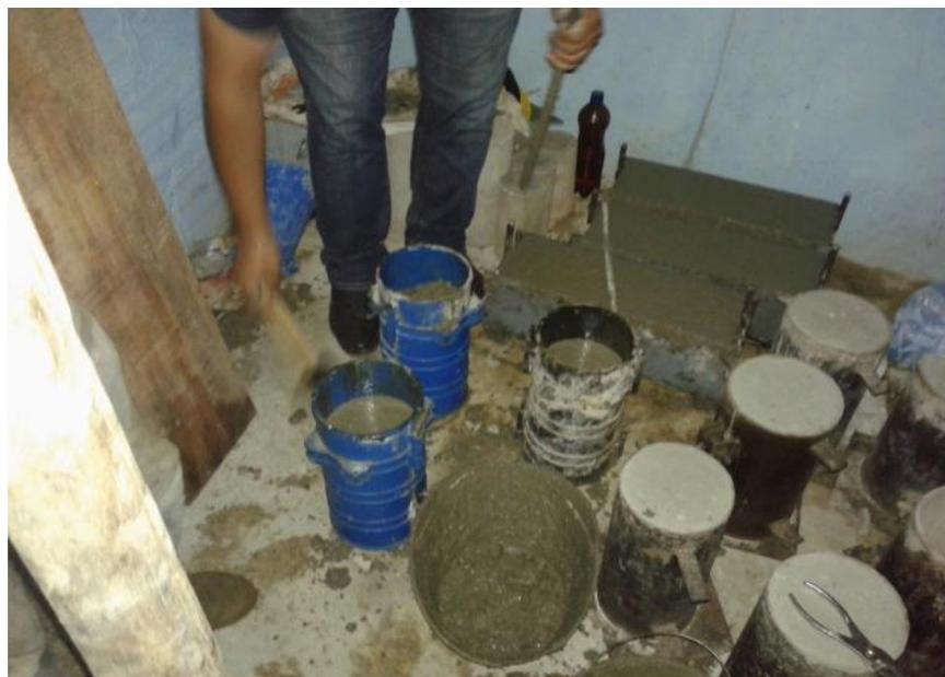
**Figura 50. Cilindros de concreto.**
