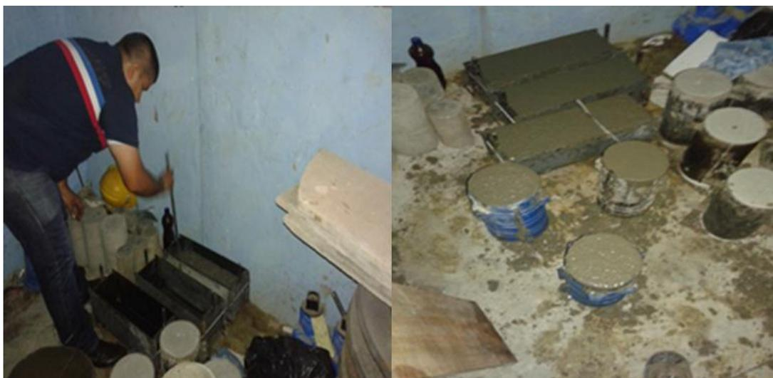
**Figura 52. Realización de vigas para ensayo.**
