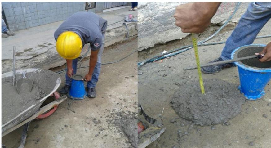
**Figura 48. Asentamiento del concreto.**
