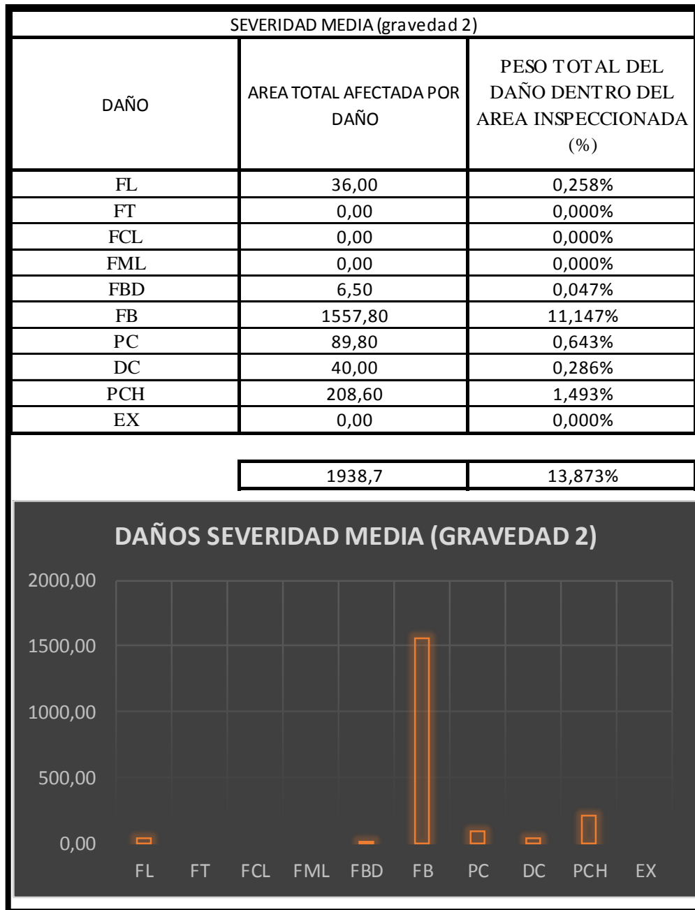
Figura 26. Daños de severidad media (gravedad 2) del carril izquierdo.
