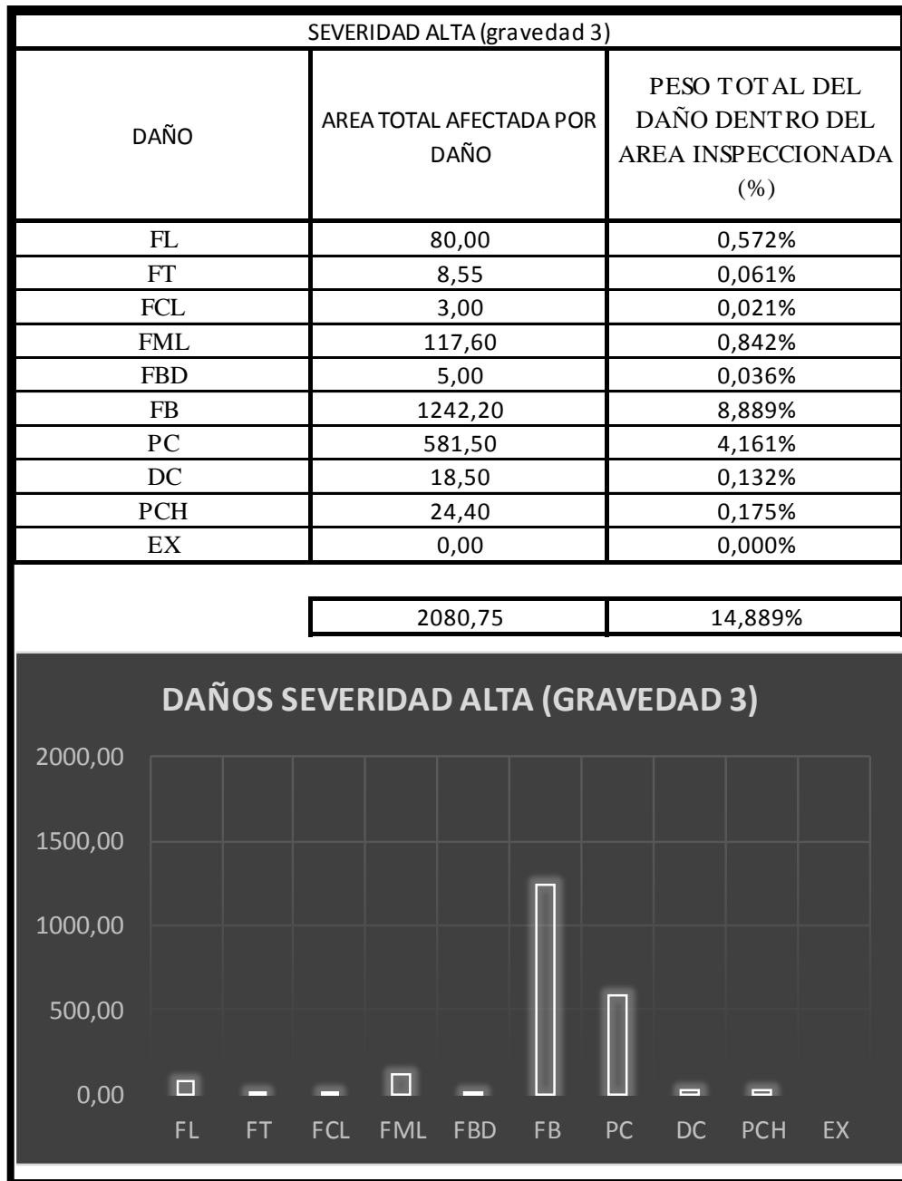
Figura 27. Daños de severidad alta (gravedad 3) del carril izquierdo.
