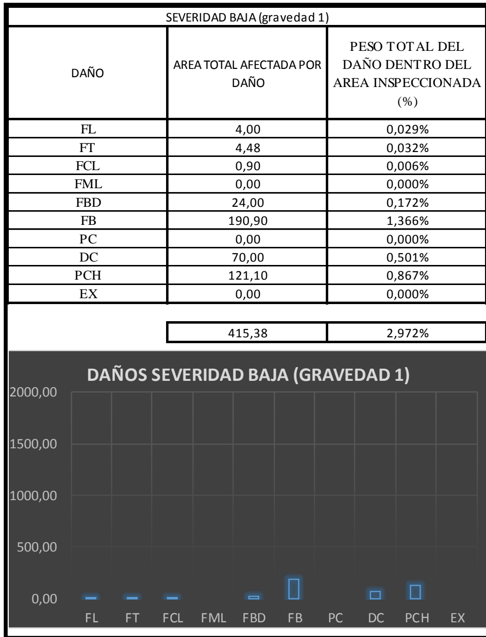
Figura 25. Daños de severidad baja (gravedad 1) del carril izquierdo.
