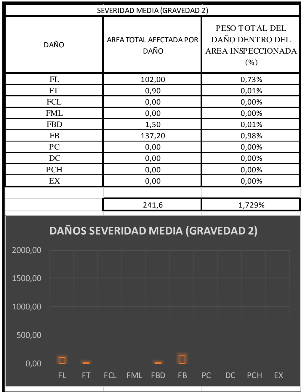
Figura 22. Daños de severidad media (gravedad 2) del carril derecho.
