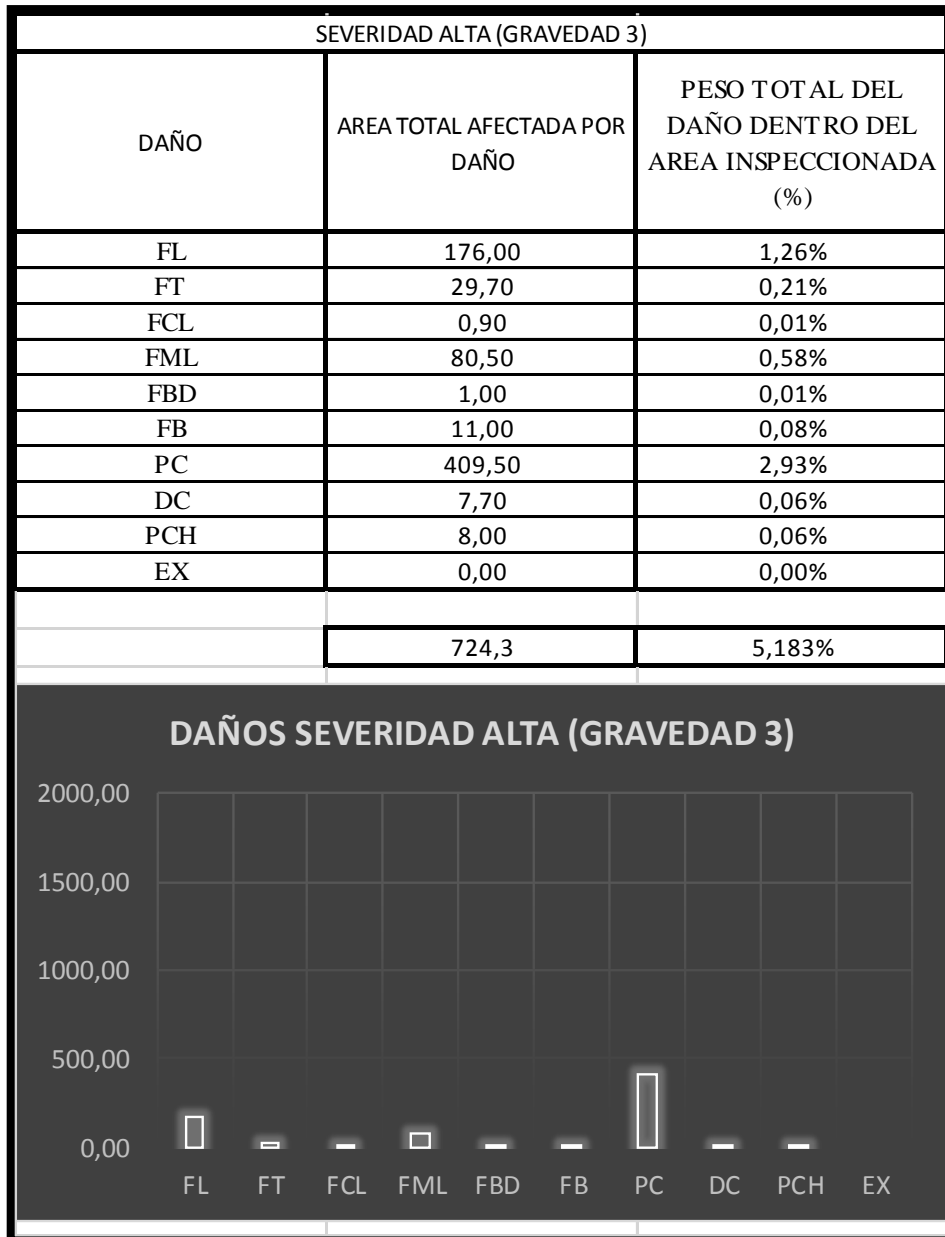
Figura 23. Daños de severidad alta (gravedad 3) del carril derecho.
