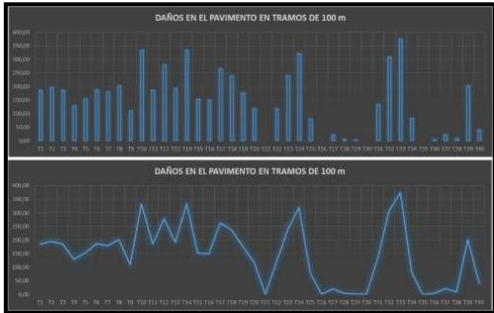
Figura 19. Daños en el Pavimento en tramos de 100 m de calzada.
