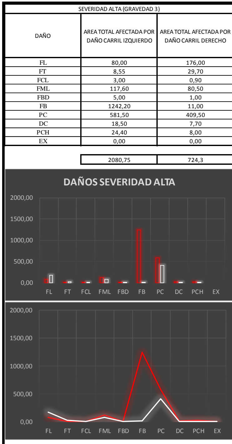
Figura 31. Daños con severidad alta (gravedad 3) en el carril izquierdo y derecho
