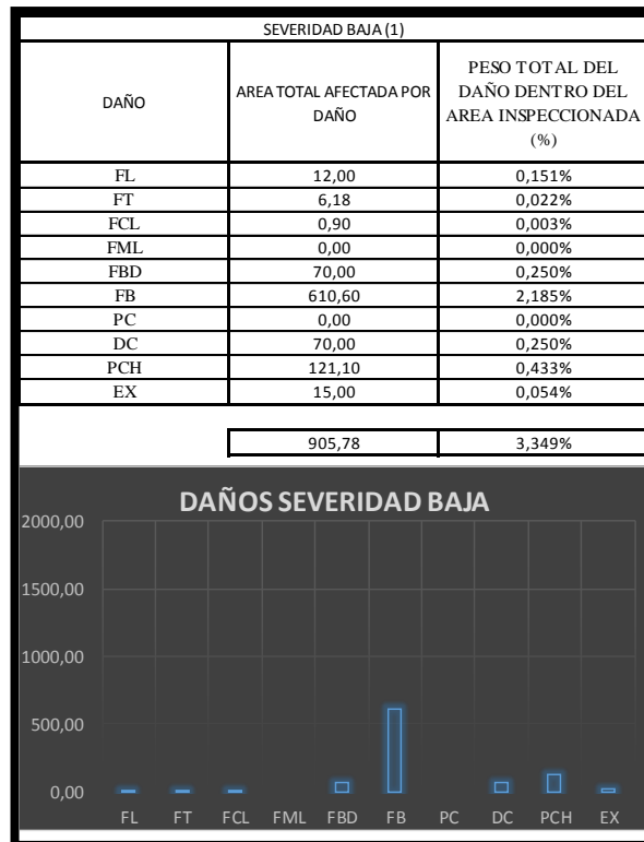
Figura 14. Daños con severidad Baja (Gravedad 1)
