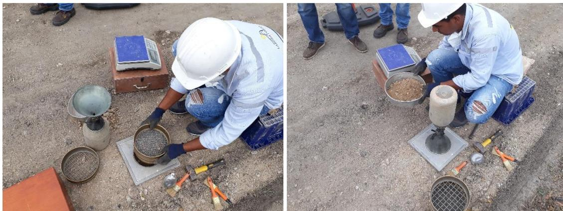
Figura 187. Ensayo de densidad en campo PR 13+850 Ruta 7008
