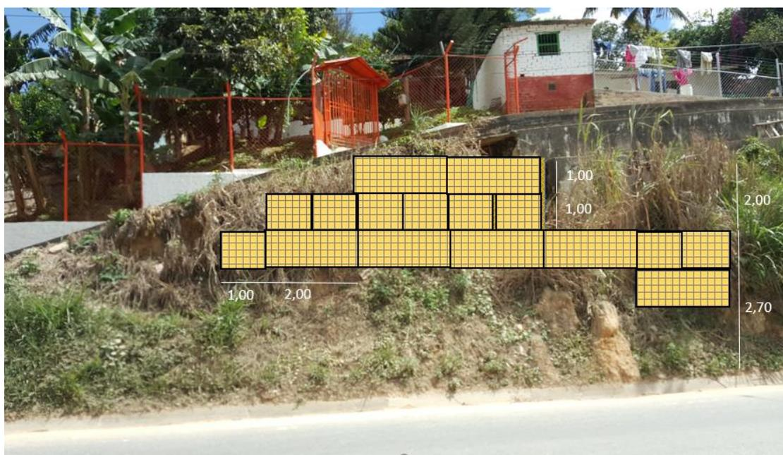
Figura 22. Dimensiones y colocación de muros en gaviones rellenos de piedra rejoneada
