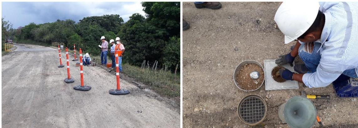
Figura 186. Ensayo de densidad en campo PR 13+800 Ruta 7008
